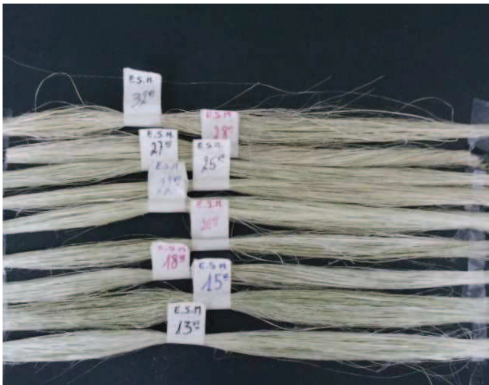
Figura 3.10. Foto de las fibras de formio obtenidas por enriado sin machacado previo
