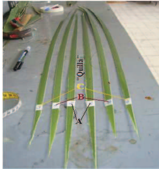
Figura 2.6. Foto de los seis segmentos obtenidos de una hoja de formio para proceder a la extracción manual de la fibra
