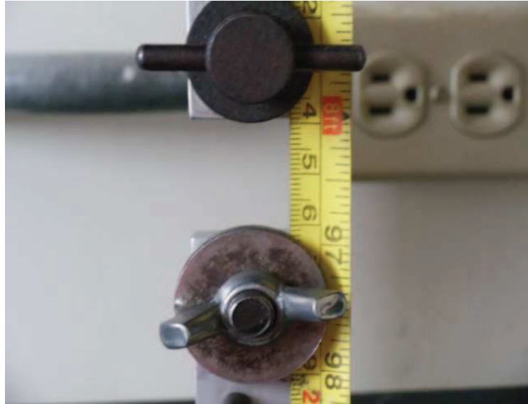
Figura 2.10. Foto de la separación inicial de las mordazas en la máquina de ensayos universales para determinar las propiedades mecánicas de las fibras de formio
