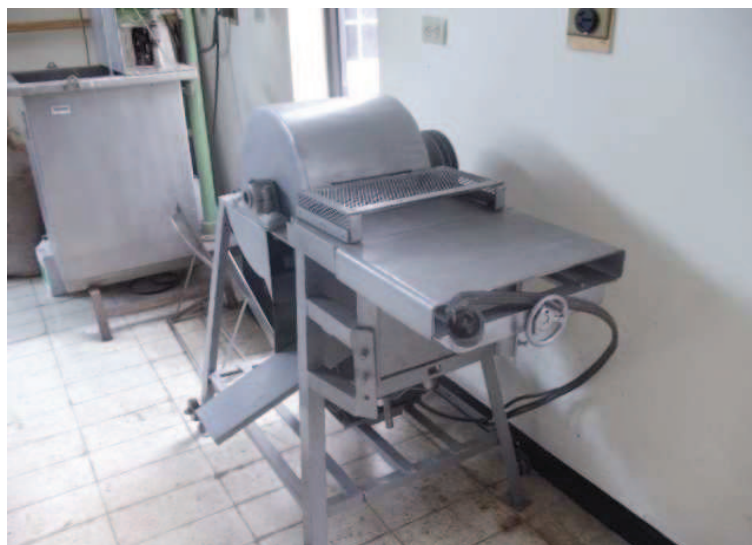
Figura 2.3. Foto de la descortezadora de cabuya usada en la extracción mecánica de las fibras contenidas en las hojas de formio
