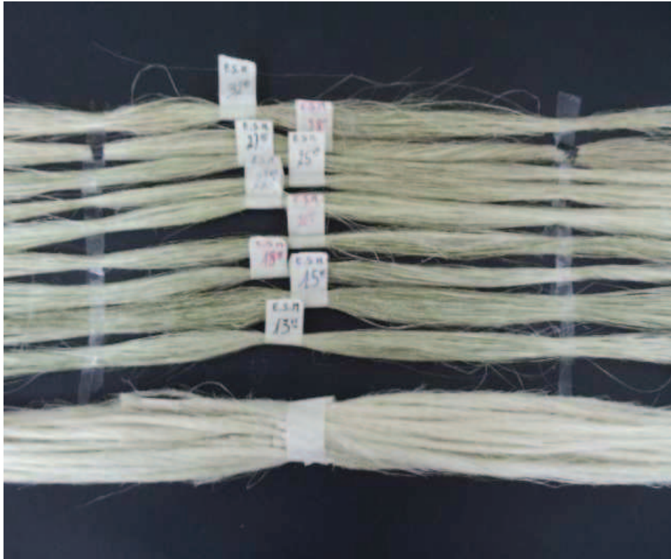
Figura 3.15. Fotografía de las fibras de formio obtenidas por descortezado (inferior) en contraste con las fibras extraídas con el proceso de enriado sin machacado
