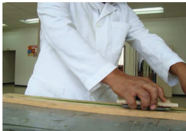
Figura 2.7. Foto del proceso de extracción manual realizado con carda
