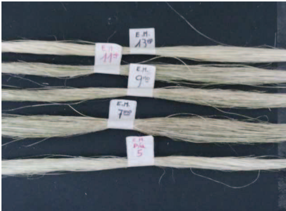
Figura 3.6. Foto de las fibras de formio obtenidas por enriado con machacado previo
