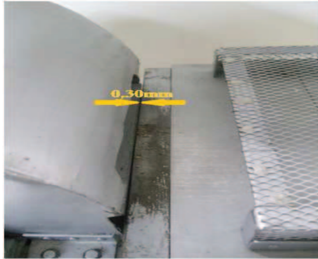
Figura 2.9. Foto de la desfibradora de cabuya con la separación paletas-mesa de 0,30 mm
