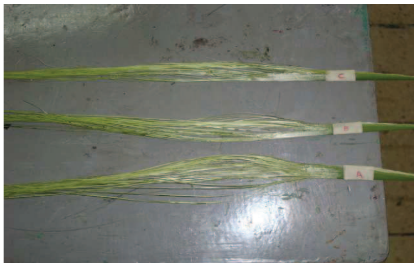
Figura 3.2. Foto de las fibras obtenidas de tres segmentos de una hoja de formio
