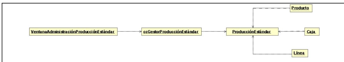
Figura 2.3- 19: Diagrama de clases de diseño para la realización del caso de uso Administración del Sistema (Subsistema Gestión Producción Estándar)
