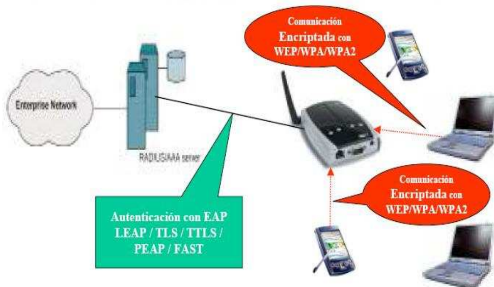
Fig. 3.2 Esquema de Seguridad Wi-Fi 802.1x
