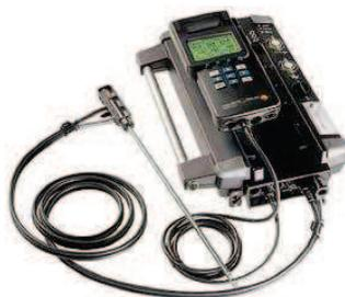
Figura 2. 6 Analizador de gases de escape
