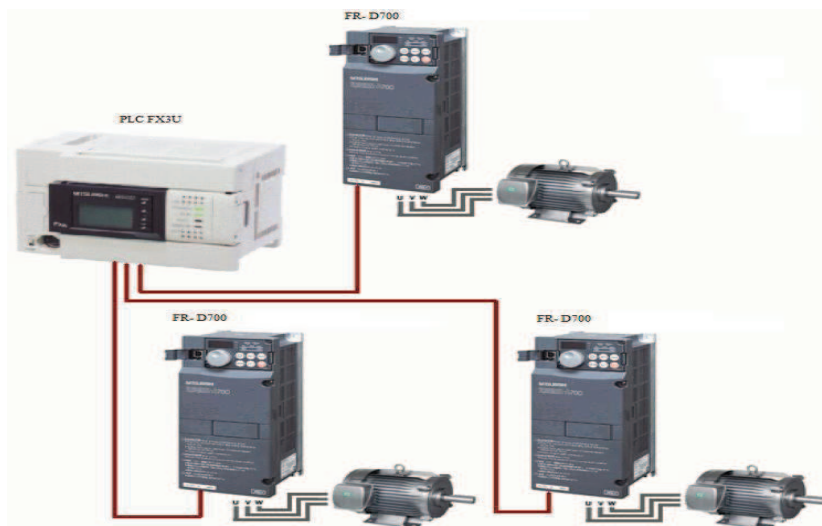
Figura 3-24 PLC FX3U – Variadores de Frecuencia D700
