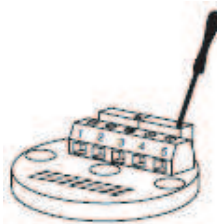
Figura 3-123 Calibración del potenciómetro I out = 20 mA
