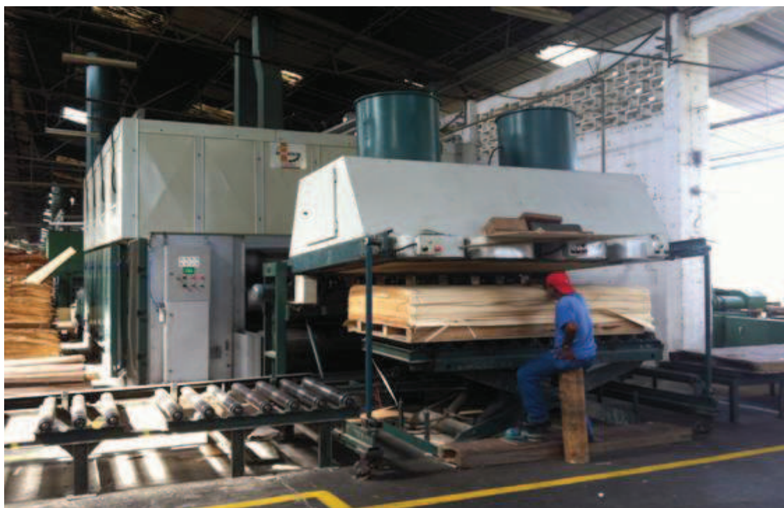
Figura 1-14 Secado de las Chapas
