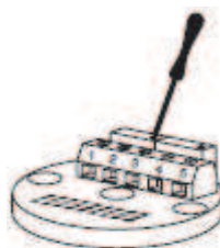
Figura 3-122 Calibración del potenciómetro I_{out} = 4 \text{ mA}
