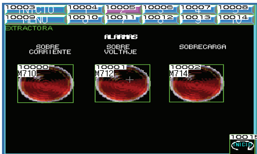
Figura 3-60 Alarmas de la Extractora
