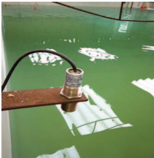
Figura 4-4 Montaje del Sensor Ultrasónico
