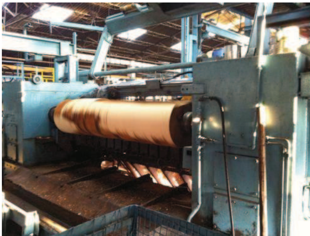
Figura 1-12 Laminado en el Torno Keller
