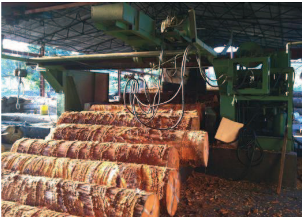
Figura 1-11 Descortezado de las trozas
