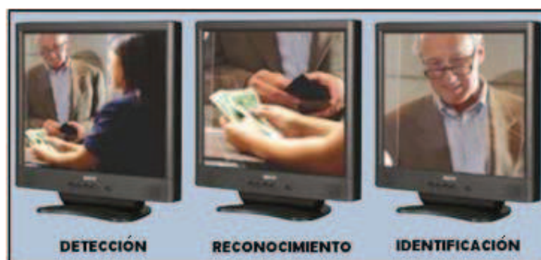
Figura 1.10 Fines de un sistema de CCTV [14]
