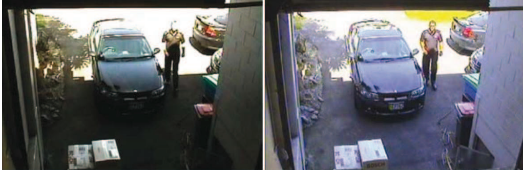
Figura 1.13 Imágenes sin compensación BLC y con compensación BLC [14]
