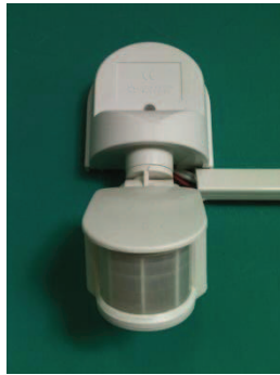
Figura 2.14 Sensor de movimiento BLITZ serie LX16C [19]
