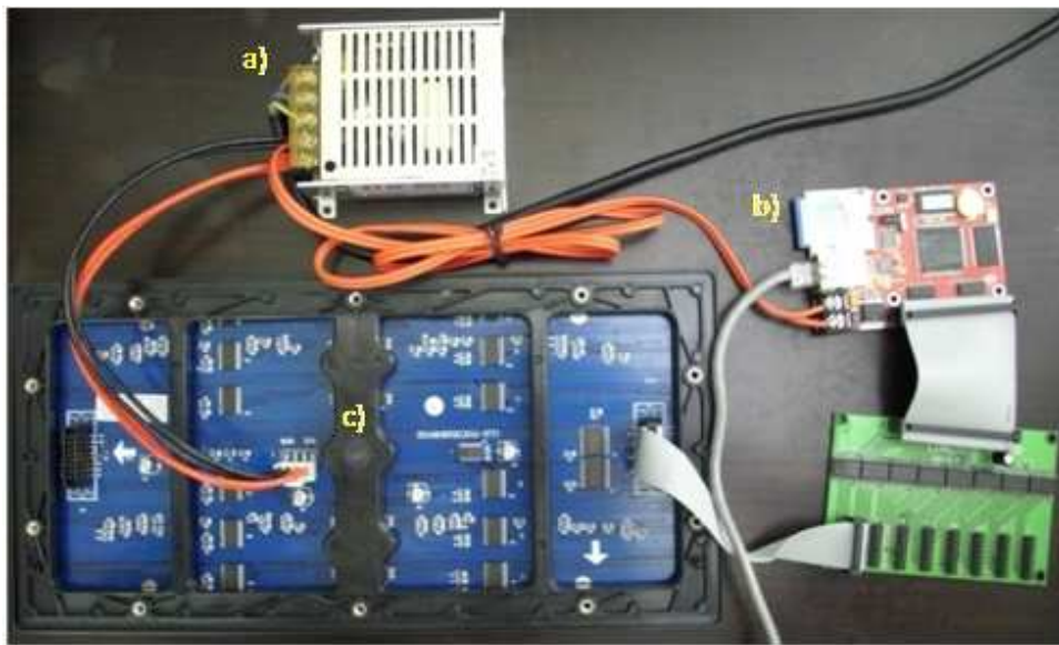
Figura. 3.29. Elementos del Sistema de Información: a) fuente de voltaje, b) circuito de control, c) matriz LED RGB 16x32 puntos.
