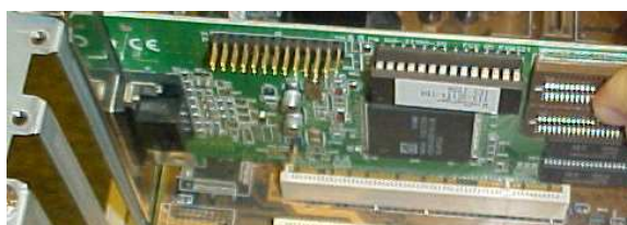
Figura N°4.5 Instalación tarjeta de telefonía
