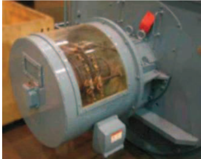
Figura 2.7. Anillos rozantes del motor síncrono
