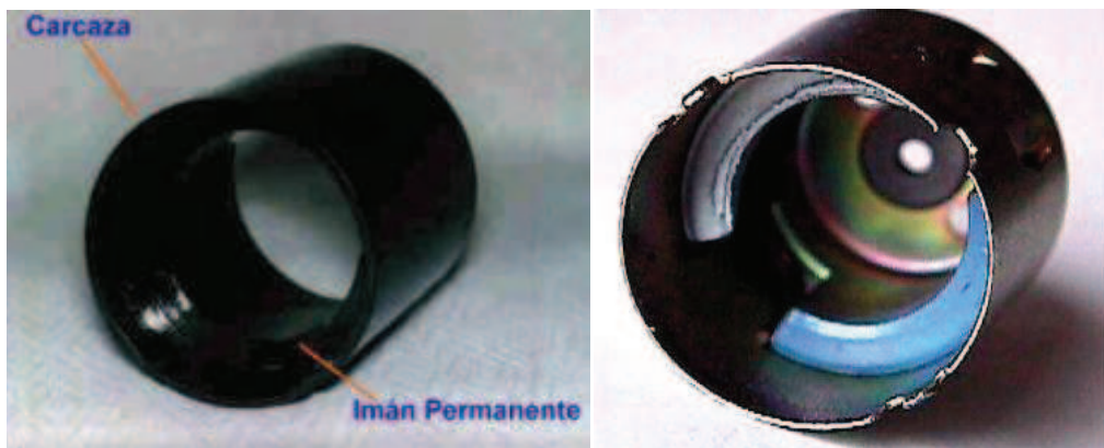
Figura 1.16. Reconocimiento motor c.c. con imanes permanentes
