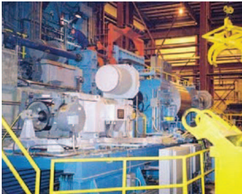
Figura 1.18. Aplicación: laminación en frío. 2 motores de corriente continua, 1.119 kW; 6 motores de corriente continua, 522 kW; 4 motores de corriente continua, 448 kW.2
