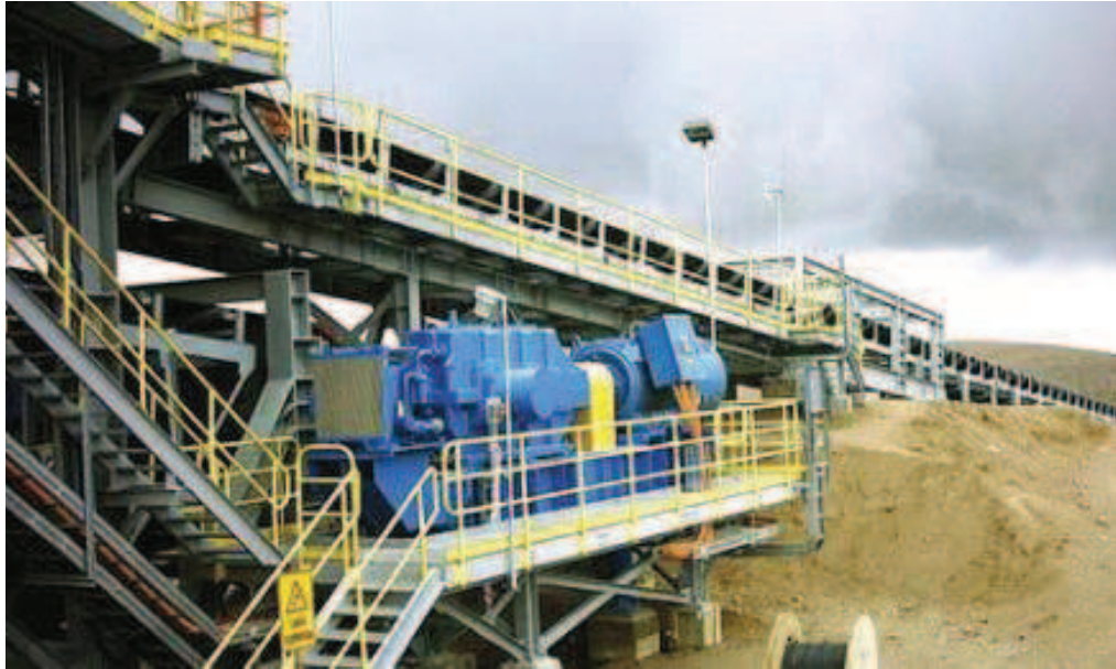
Figura 3.23. Aplicación: cintas transportadoras. Motor de inducción HGF630, 2.788 HP, 2.300 V, 6 polos
