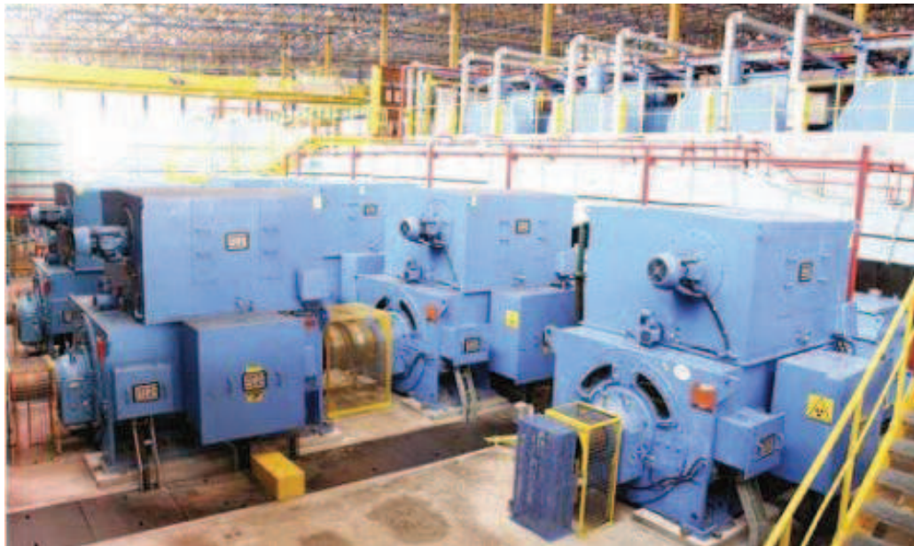
Figura 2.18. Aplicación: laminación. 7 motores síncronos SDL800, 3.000 kW, 3.100 V
