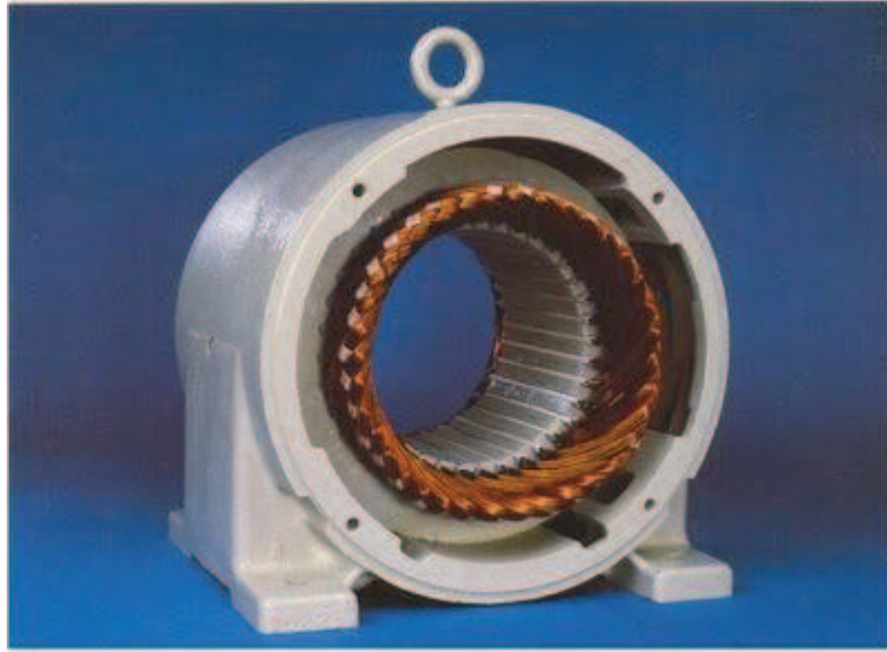
Figura 3.2. Estator motor asíncrono trifásico c.a.
