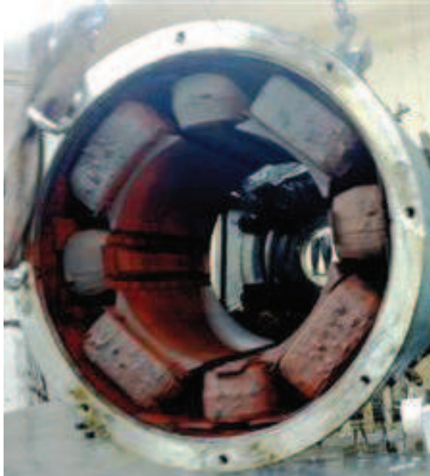
Figura 1.3. Estator de un motor c.c. tetra polar se puede observar la culata, los 4 polos principales de mayor tamaño a los 4 polos auxiliares
