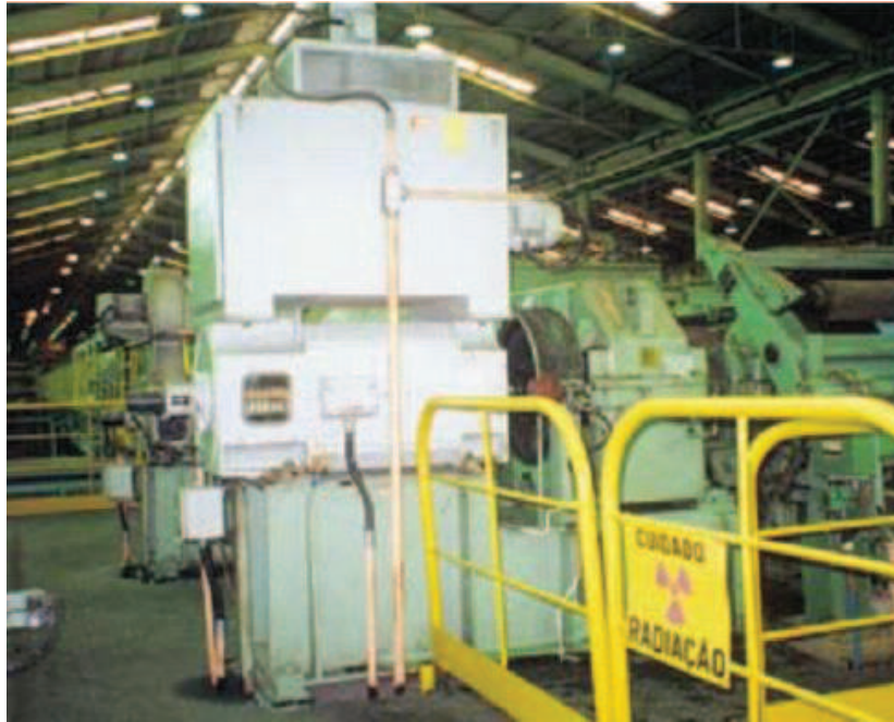
Figura 1.17. Aplicación: cilindro tensor de tiras. Motor c.c. de 325 kW.1
