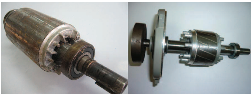
Figura 3.3. Rotor jaula de ardilla motor asíncrono trifásico c.a.
