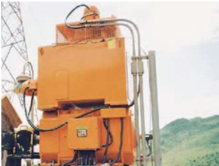
Figura 1.20. Aplicación: cintas transportadoras. Motor c.c. 350kW4
