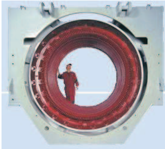
Figura 2.5. Estator de un motor c.a. síncrono
