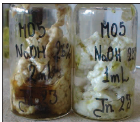
Figura AIX.2. Fotografía de las mezclas reactivas resultantes de la síntesis por MO de la 1,2-Benzopirona al nivel 10 de potencia y 1 min de irradiación, sin sílica gel, a 2/3 como relación molar entre reactivos y al 5,9 y 11,8 % mol del catalizador básico
