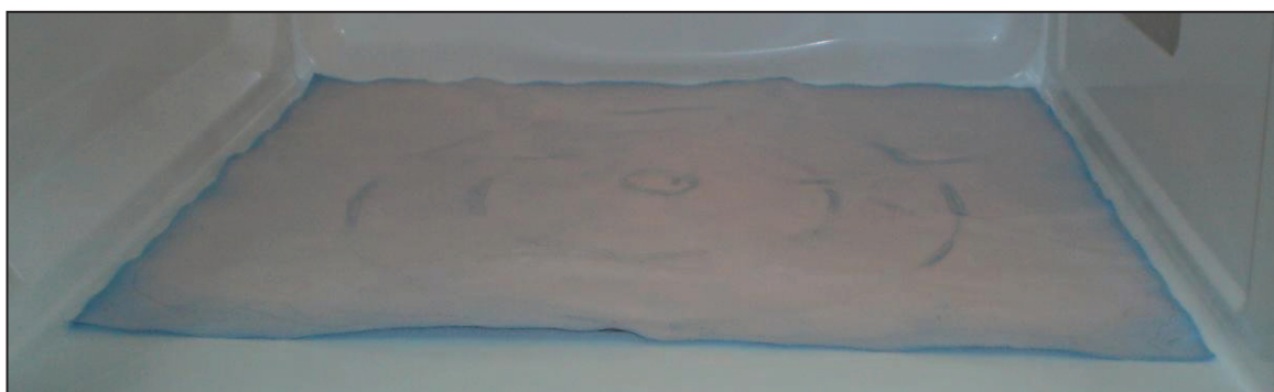
Figura AI.1. Fotografía de la caracterización de la superficie total del horno microondas sin el plato giratorio
