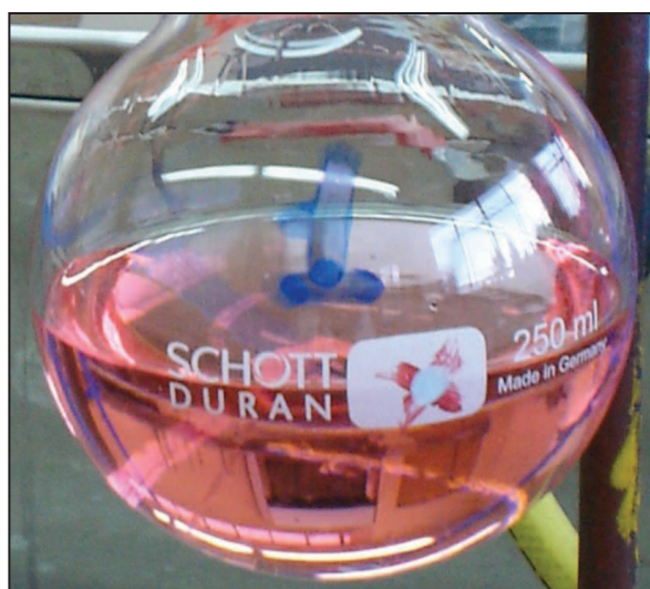
Figura AVII.4. Fotografía de la síntesis convencional de la ECC con el uso de ácido clorhídrico, mediante la reacción de Pechmann
