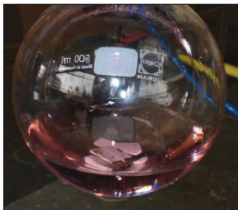
Figura AVII.2. Fotografía de la síntesis de la 1,2-Benzopirona con el uso de un catalizador ácido (ácido clorhídrico), mediante la reacción de Pechmann
