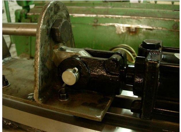
*Unión deslizador-cilindro hidráulico.*
