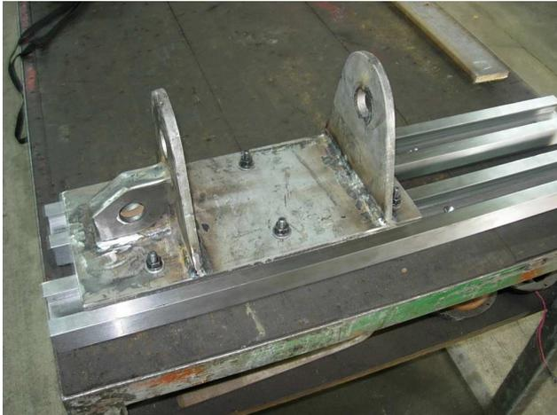
*Guías hembra fresadas y deslizador.*
