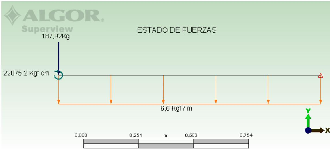
*Figura 2.15 Estado de fuerzas para el brazo interno, caso a flexión.*
