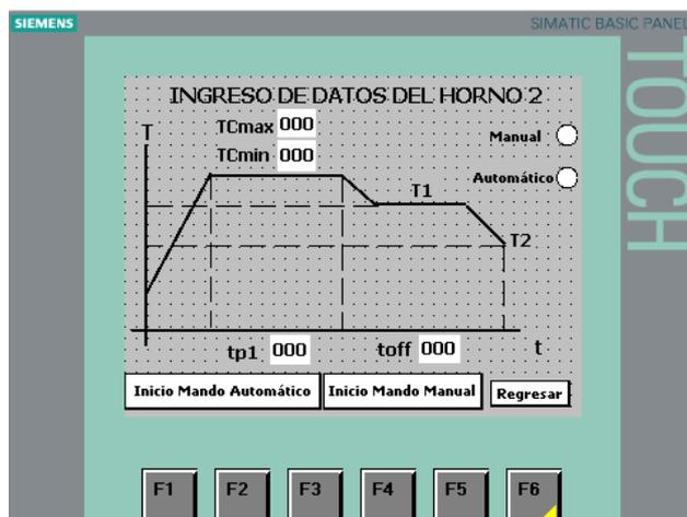
*Figura J: Ingreso de datos del Horno 2 para mando automático*
