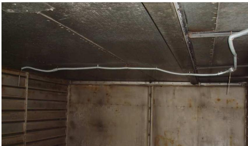
**Figura 2.36: Instalación de termopares en el Horno 1**
