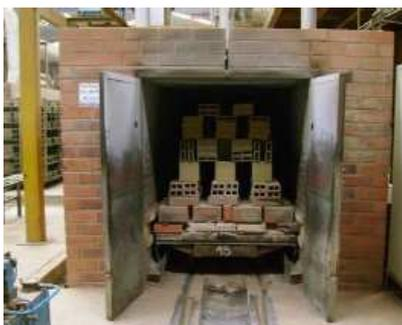
*Figura 1.7: Horno para cocer ladrillos*
