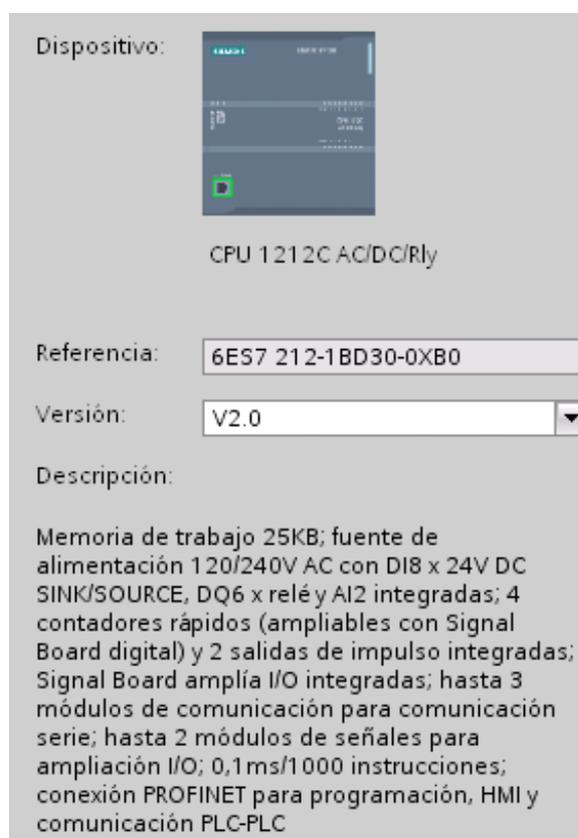
**Figura 3.14: Características generales del PLC S71200 CPU1212C**
