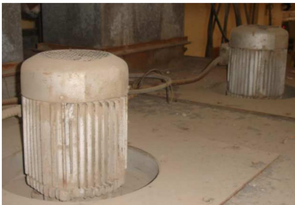
**Figura 2.9: Motores de recirculación Horno1**
