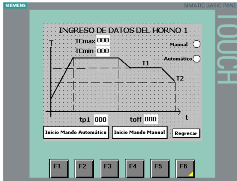
**Figura H: Ingreso de datos del Horno 1 para mando automático**
