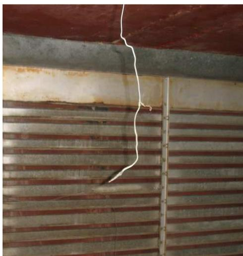
**Figura 2.11: Termopar tipo K, instalado en el horno industrial 2**
