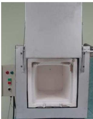
*Figura 1.6: Horno para cocer materiales acerosos*
