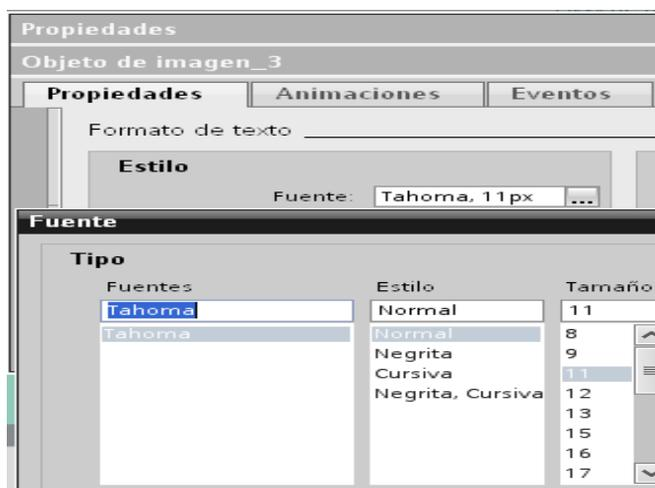
**Figura 3.24: Configuración de texto en el HMI**
