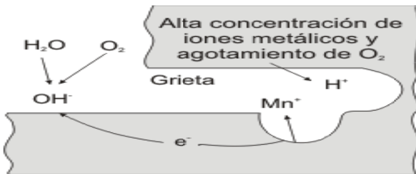
FIG.39 CORROSIÓN EN FISURAS
