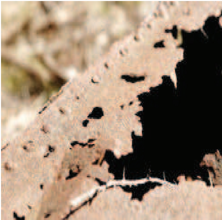
FIG 36 DESGASTE POR OXIDACIÓN
