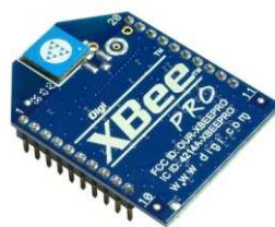
Figura 1.21 XBee pro serie 1, tomado de [28]
