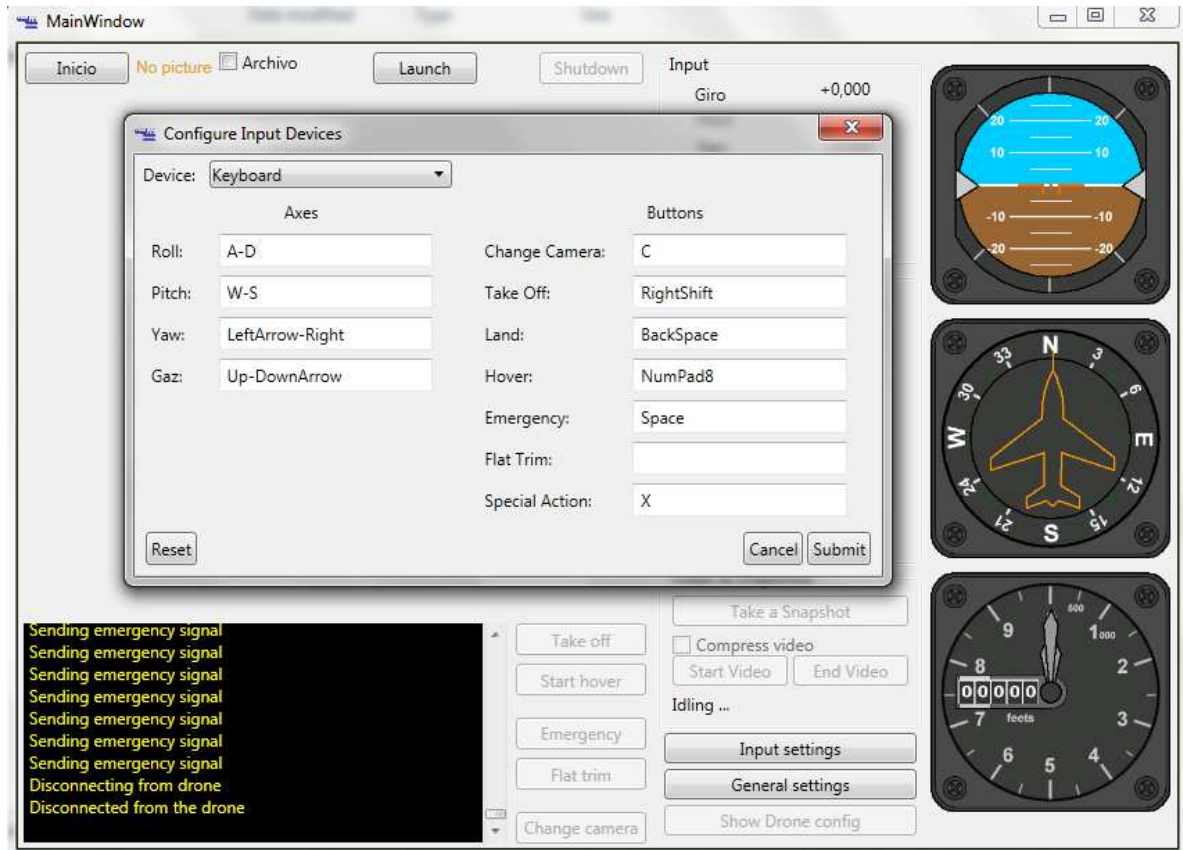
Figura A.9 Ventana de inicio del AR.Drone Control .NET
