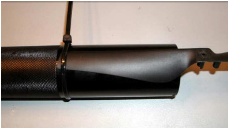
Figura 4.6 Modo de enderezar la curvatura de las hélices
