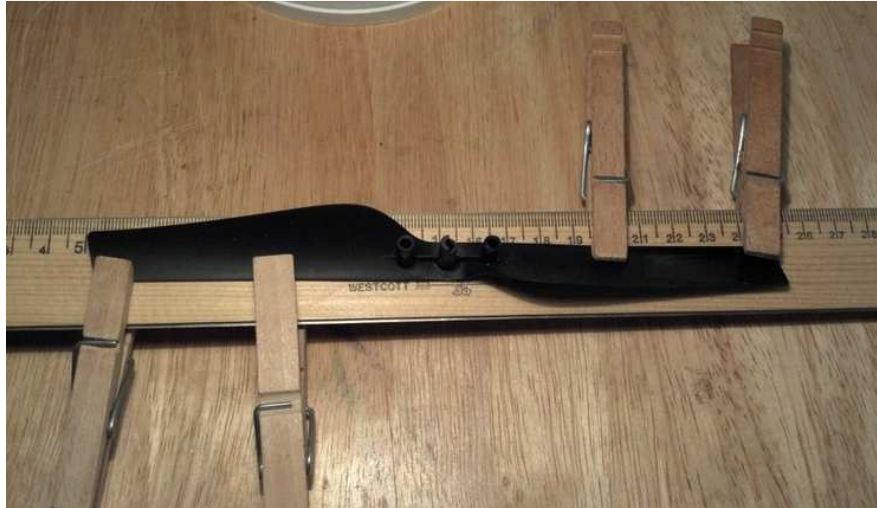
Figura 4.7 Forma de enderezar las hélices
