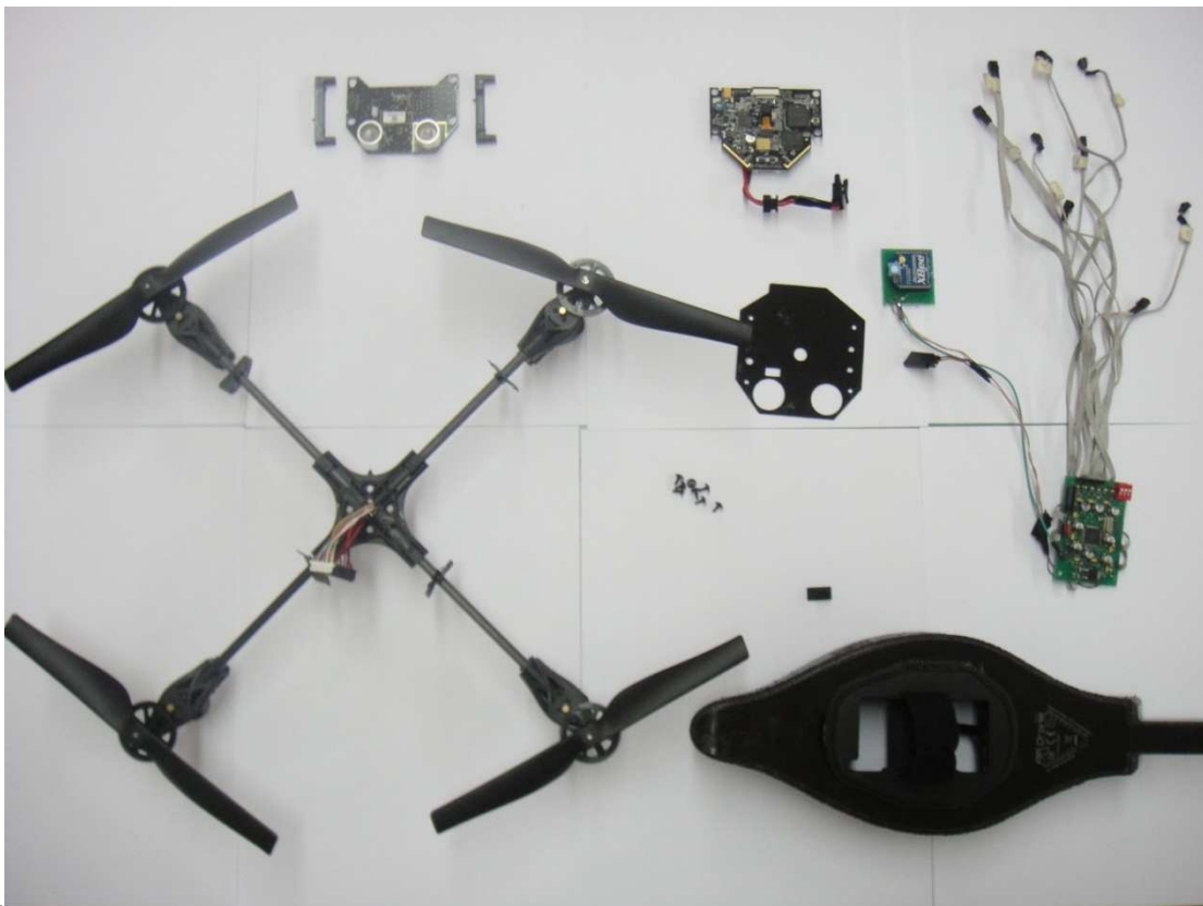
Figura 4.5 Partes constitutivas del cuadricóptero AR Drone.
