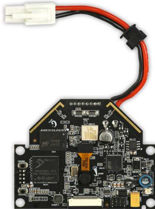
Figura 2.9 Sistema informático y procesador principal
