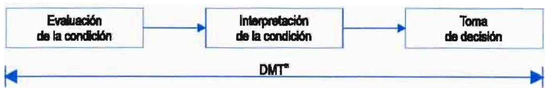
Fig. 4 Típica tarea de mantenimiento condicional
