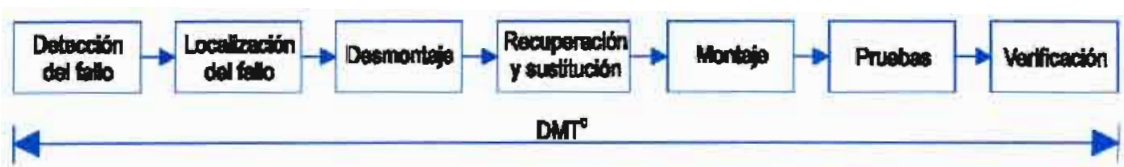
Fig. 3 Típica tarea de mantenimiento correctivo
