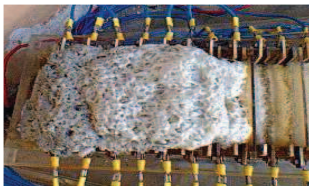
Figura 3.11. Formación de lodos flotantes durante el proceso de descontaminación del lixiviado por electrocoagulación con ánodos de aluminio (Reactor de 12 L, 20 celdas electroquímicas, 20 A y flujo de alimentación de 10 L/h)
