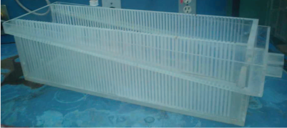
Figura 3.7. Reactor de electrocoagulación de 12 L
