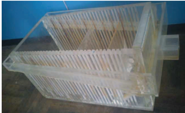
Figura 3.8. Reactor de electrocoagulación de 6 L
