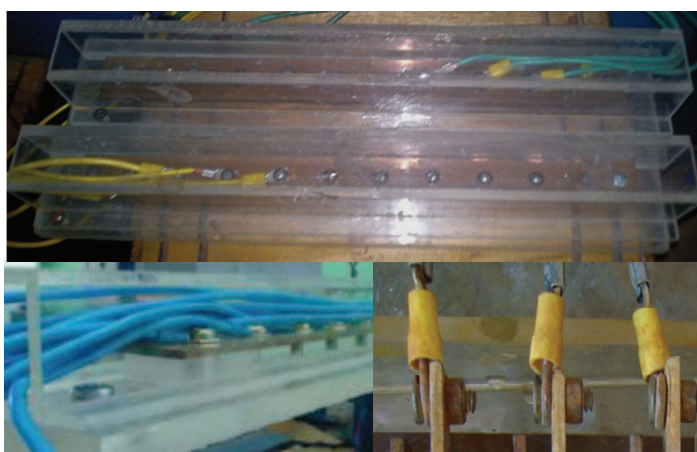
Figura 3.6. Pletinas de cobre y conexiones de los cables con las celdas electroquímicas del reactor
