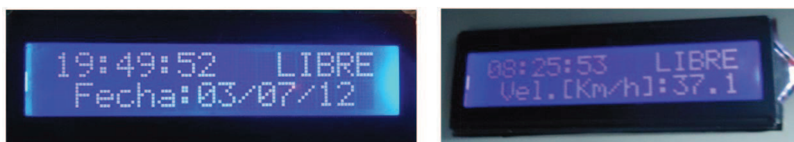
Figura 4.7 Pantallas indican estado LIBRE, se puede observar además la hora, fecha y velocidad del vehículo
