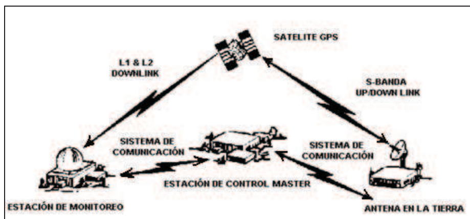
Figura 1.16 Segmento de control [3]
