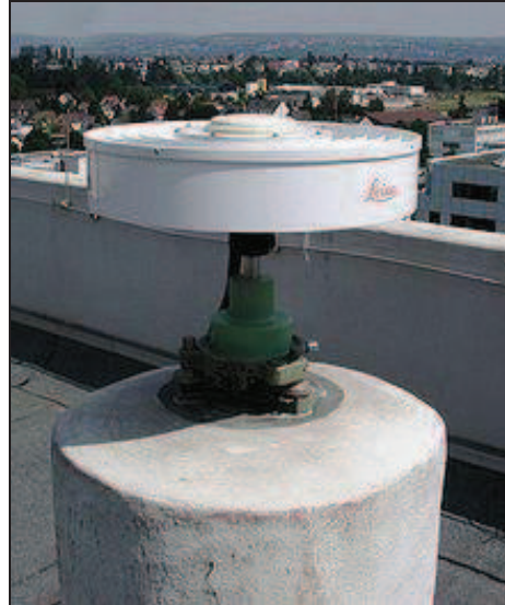
Figura 1.22 Estación Leica de referencia DGPS [3]
