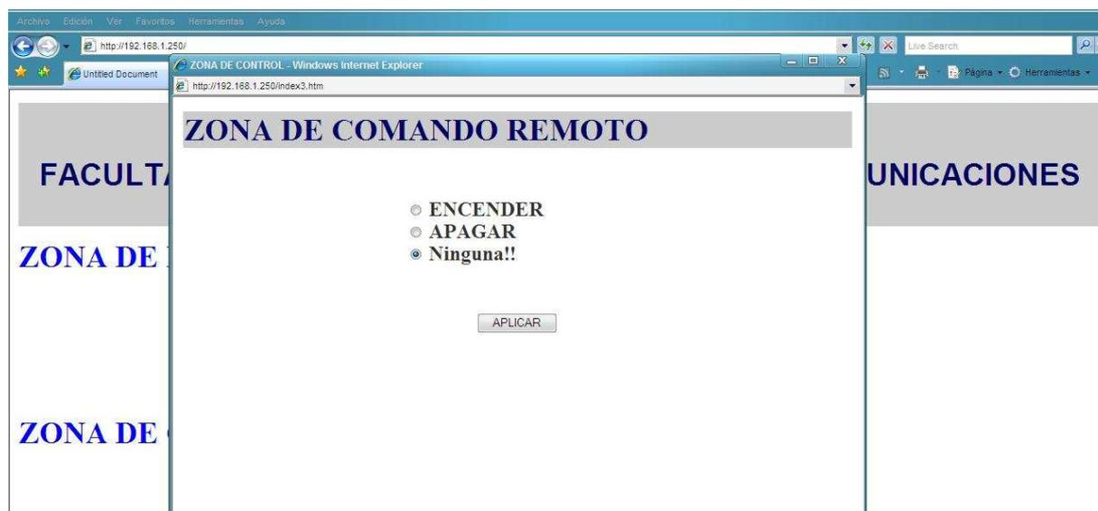
Figura 3. 8Página de control del módulo de monitoreo y control del sistema de calefacción.
