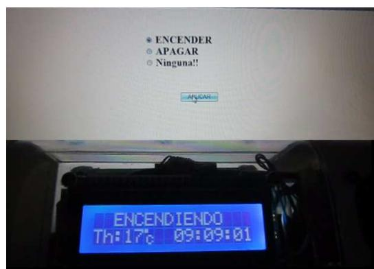
**Figura 3. 21** Encendido y Apagado del módulo desde el sistema de calefacción
