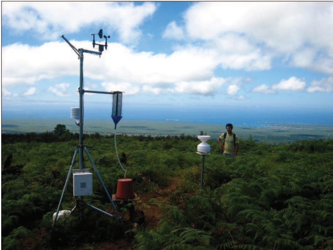
FIGURA 4.9 Disposición de la instrumentación para medición de variables meteorológicas en la estación Media Luna.
