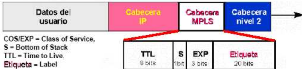
FIGURA 1.4. ESTRUCTURA DE UNA CABECERA GENÉRICA MPLS
