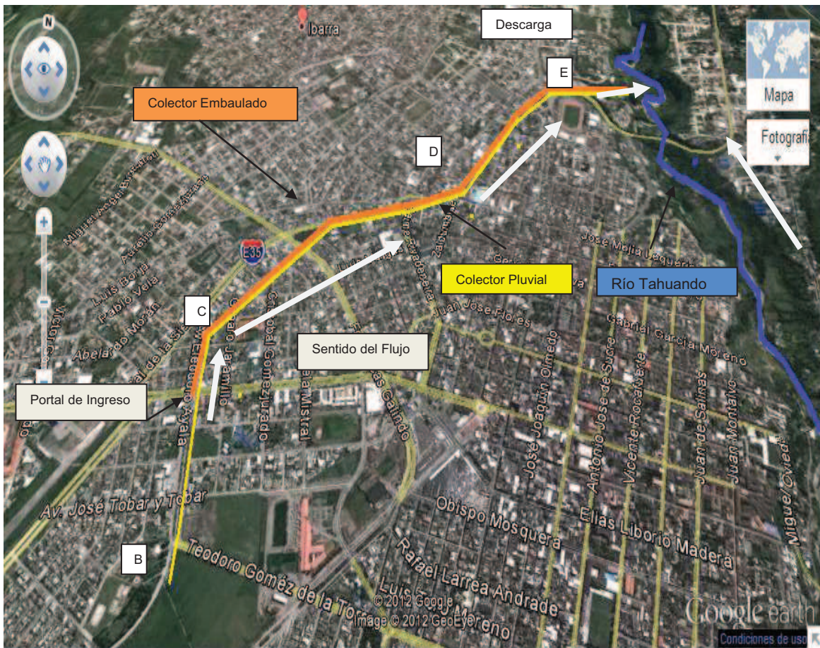
FIGURA 2. 9 PLANIMETRÍA E IMPLANTACIÓN DEL COLECTOR AJAVÍ EN LA CIUDAD DE IBARRA
