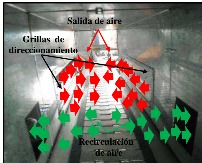
Fig. 2.17. Cámara de termoencogido
