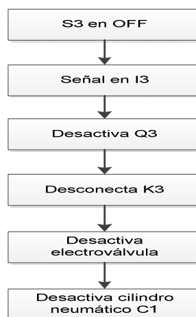
Fig. 3.14 Desconexión de la etapa de retención.
