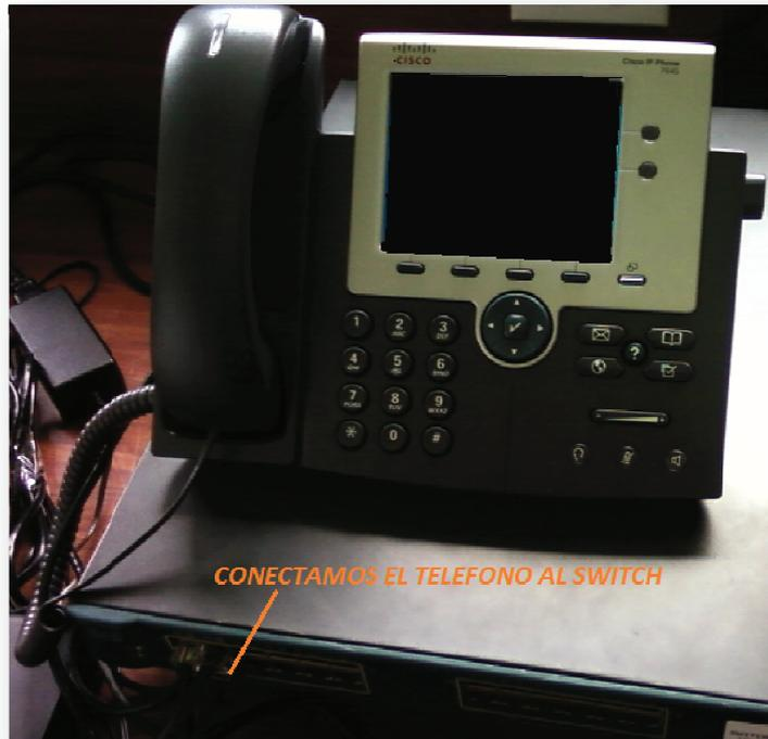
Figura 3.35 Conexión de teléfono Cisco IP7945G al Switch
