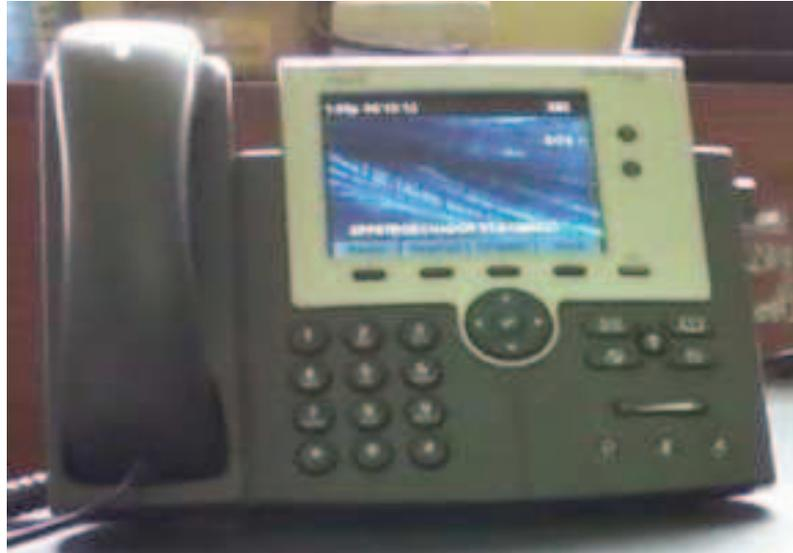
**Figura 3.20 Teléfono CISCO IP7945G**
