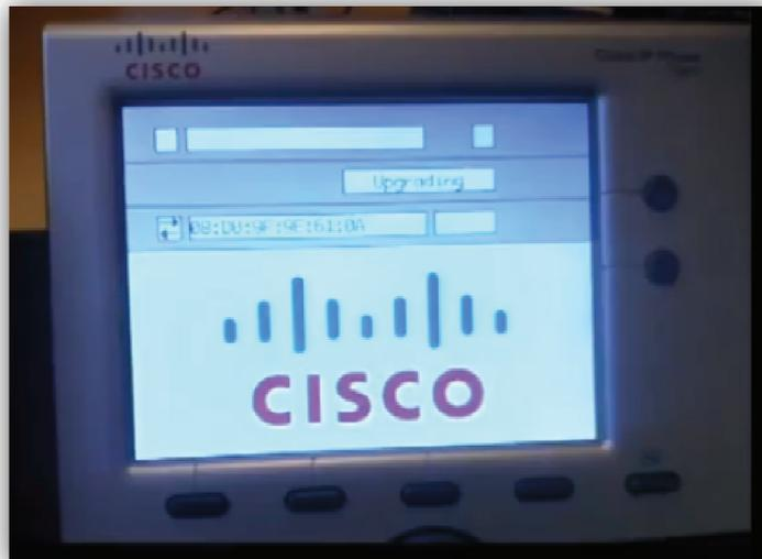
Figura 3.36 Inicialización del teléfono Cisco IP7945G
