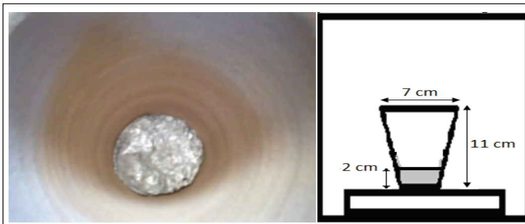
Figura 2.10 Láminas de aluminio compactadas dentro de crisol
