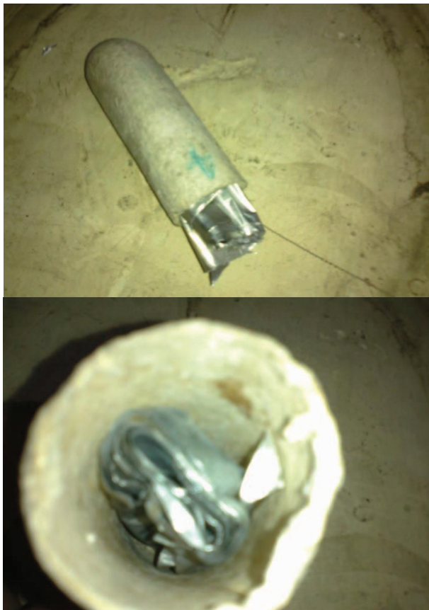
Figura 2.7 Láminas de polietileno/aluminio dentro del cartucho de celulosa
