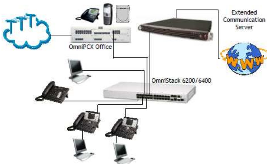
Figura 1- 2: Topología para funcionamiento de telefonía IP
