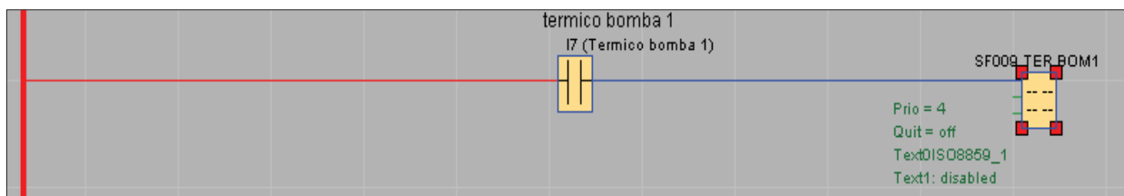
Figura. 16.7. Esquema de la programación de la gestión mensajes de estado y alarma visualizados en la pantalla LOGO TD.
