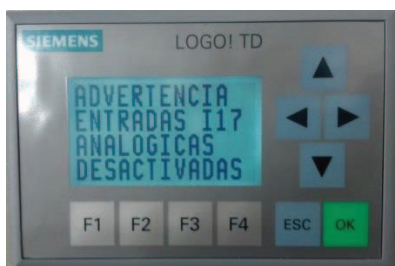
Figura. 17.4. Comprobación de mensajes en la pantalla LOGO TD. Fuente: Propia.
