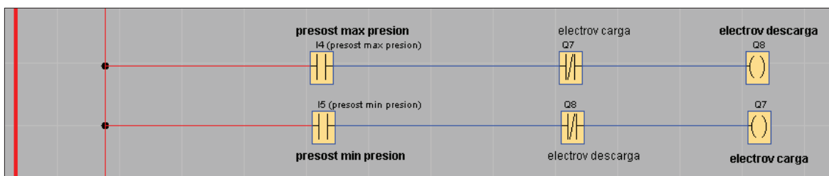
Figura. 16.1. Esquema de la programación de la gestión de carga y descarga de aire en el tanque de expansión hecho en LOGO SOFT CONFORT V6.1.
