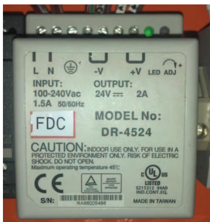
Figura. 9.7. Fuente de alimentación de 24V CC, 5A CC.
