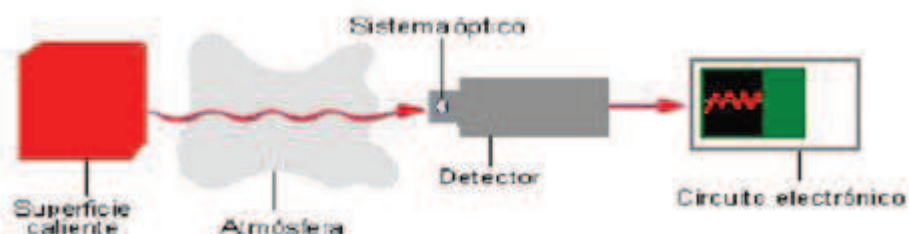
Figura.2.8. Diagrama de la operación del pirómetro.
