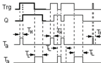
Figura.13.4. Cronograma del temporizador de retardo a la conexión/desconexión.
