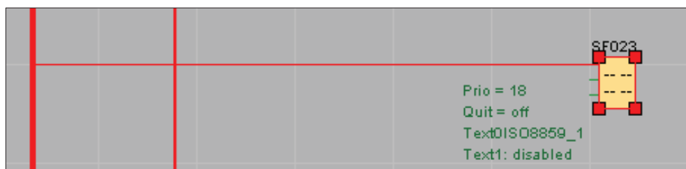
Figura. 16.5. Programación de la visualización de estado de entradas analógicas en la pantalla LOGO TD hecho en LOGO SOFT CONFORT V6.1.
