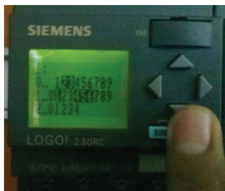
Figura. 17.1. Verificación de entradas en el LOGO! 230 RC
