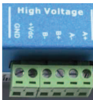
Figura 3.36 Bornera del driver para alimentación y bobinados.
