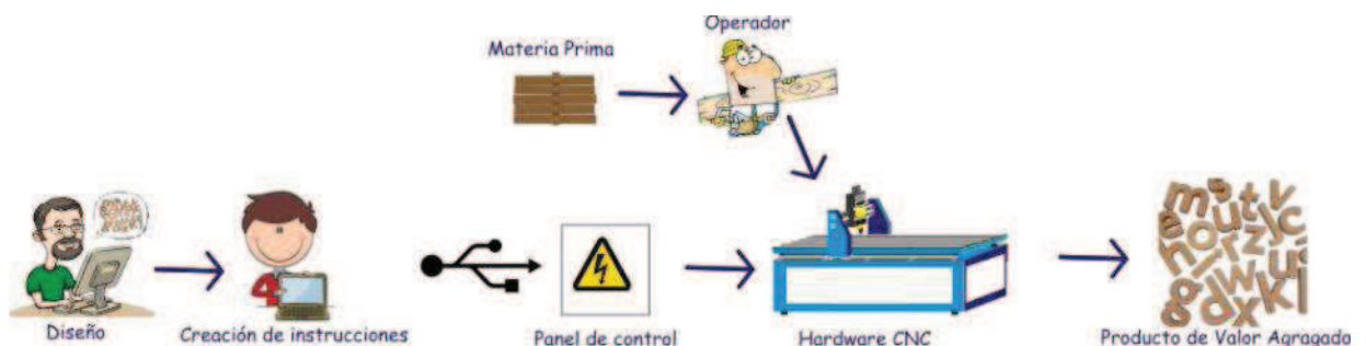
Figura 2.3 Ilustración del proceso para realizar el mecanizado CNC.
