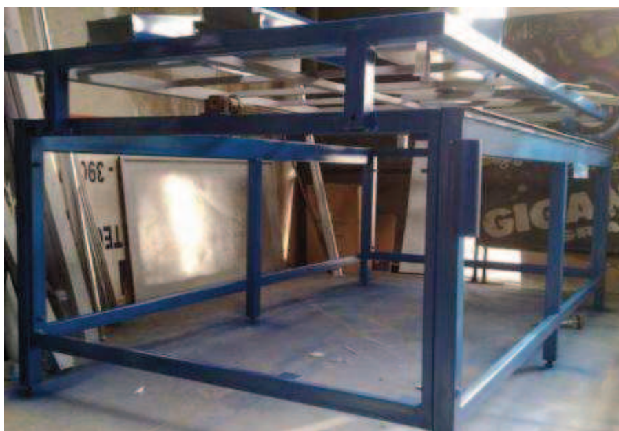
Figura 1.37 Mesa principal ensamblada.
