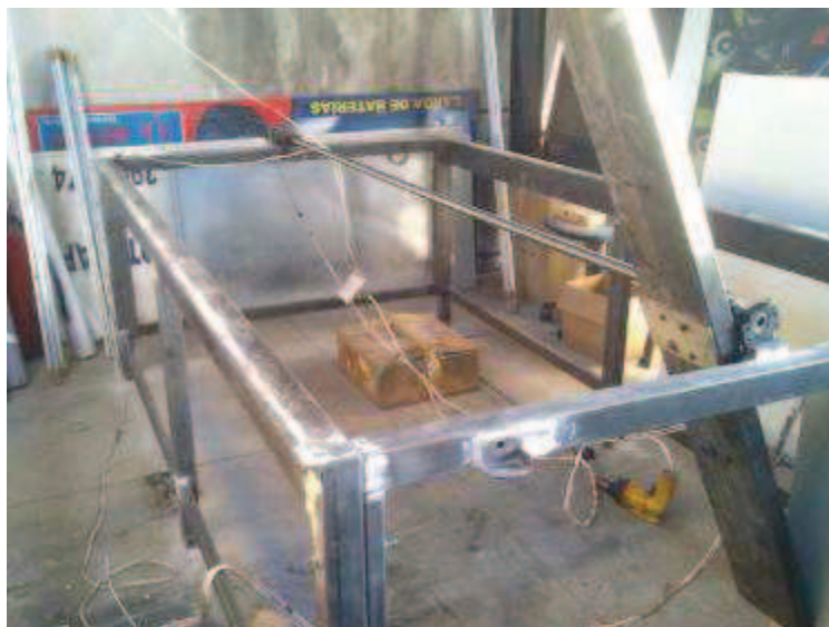
Figura 1.33 Estructura principal más sistema de transmisión eje X.
