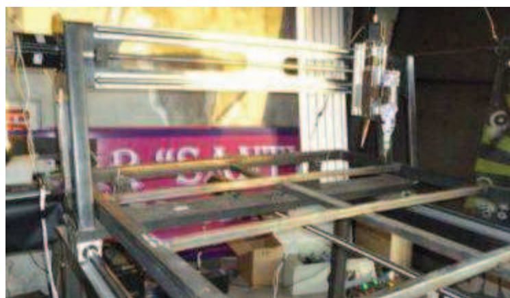
Figura 1.35 Centro de mecanizado CNC ensamblado, primeras pruebas.
