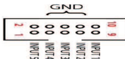
Figura 3.52 Puerto para entradas de control.
