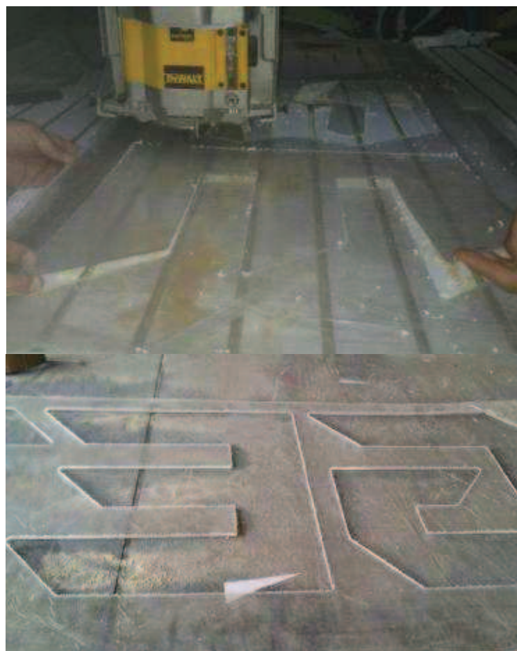
Figura 4.5 Corte sobre acrílico de 4mm de espesor.
