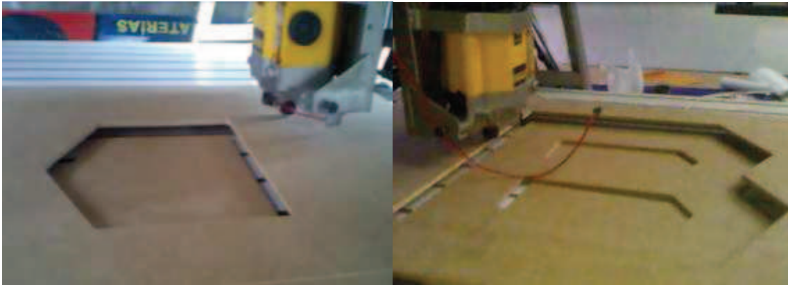
Figura 4.4 Corte sobre MDF de 6mm de espesor.
