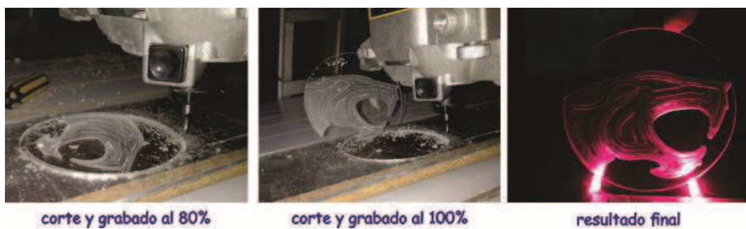
Figura 4.18 Proceso de corte y grabado sobre acrílico.
