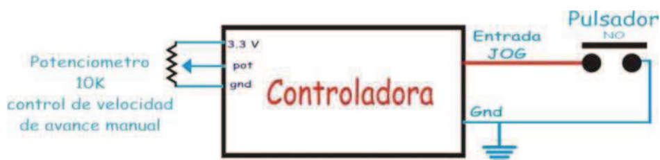
Figura 3.50 Ejemplo conexión a la controladora del posicionamiento manual.
