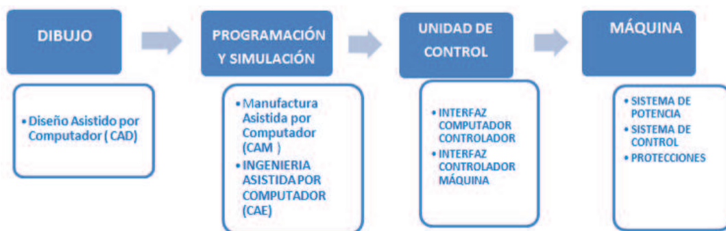
Figura 2.2 Red proceso – subprocesos de un centro de mecanizado CNC.
