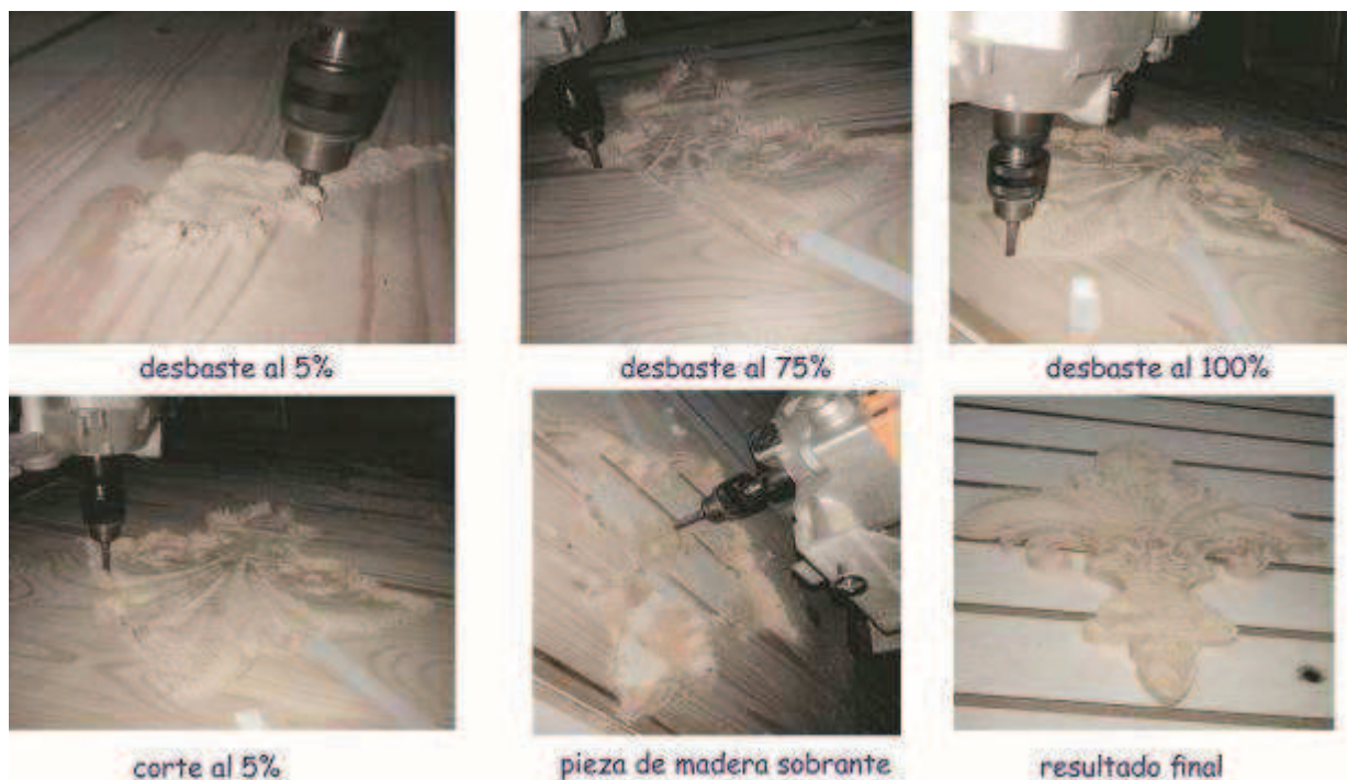
Figura 4.12 Corte y desbaste en 3d sobre madera.
