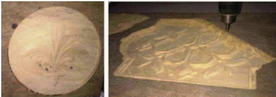
Figura 4.9 Mecanizados realizados en tres dimensiones.
