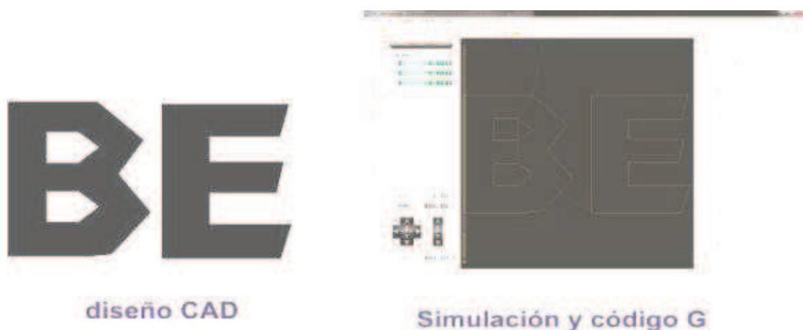
Figura 4.3 Proceso CAD – Post procesador.
