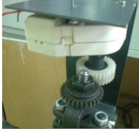
Figura 2.6 Montaje de la servo válvula
