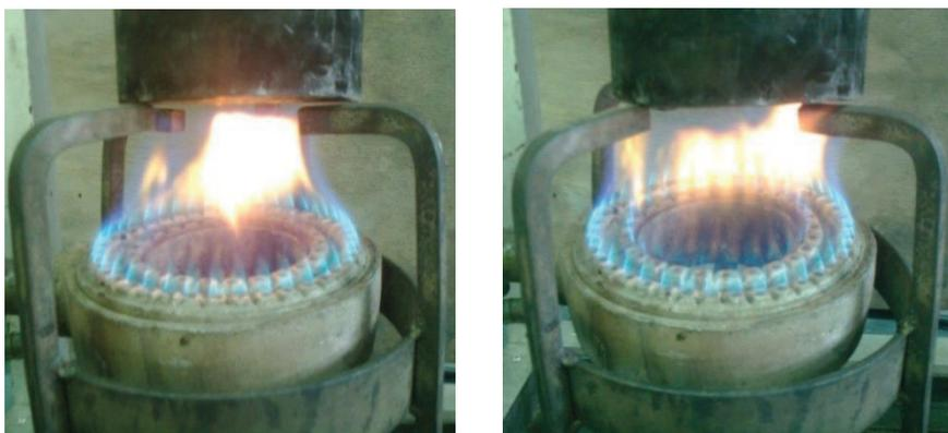
Figura 4.5 Quemador con la mezcla de los dos gases
