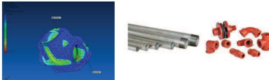
Figura 2.4 Simulación de presión en tubería de hierro
