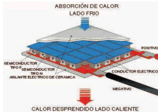
Figura 1.12 Principio de Funcionamiento celda Peltier (28)
