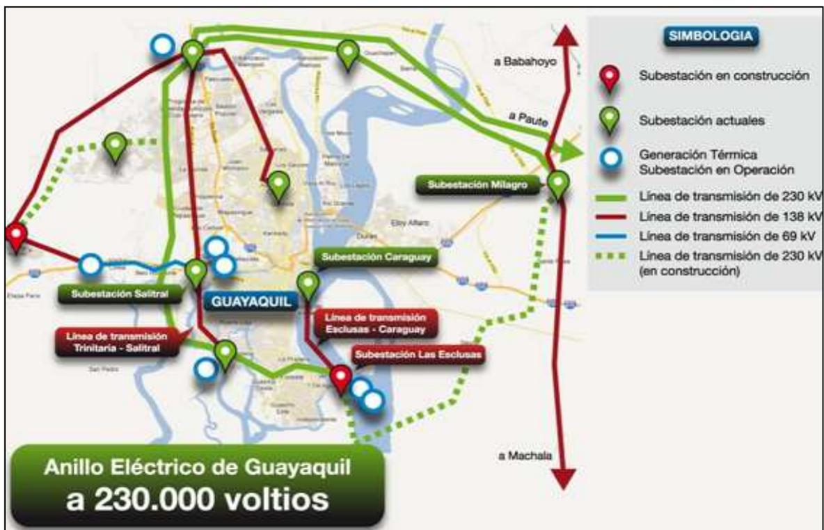
FIGURA: 1.11 ANILLO ELECTRICO DE GUAYAQUIL 230 KV<sup>16</sup>
