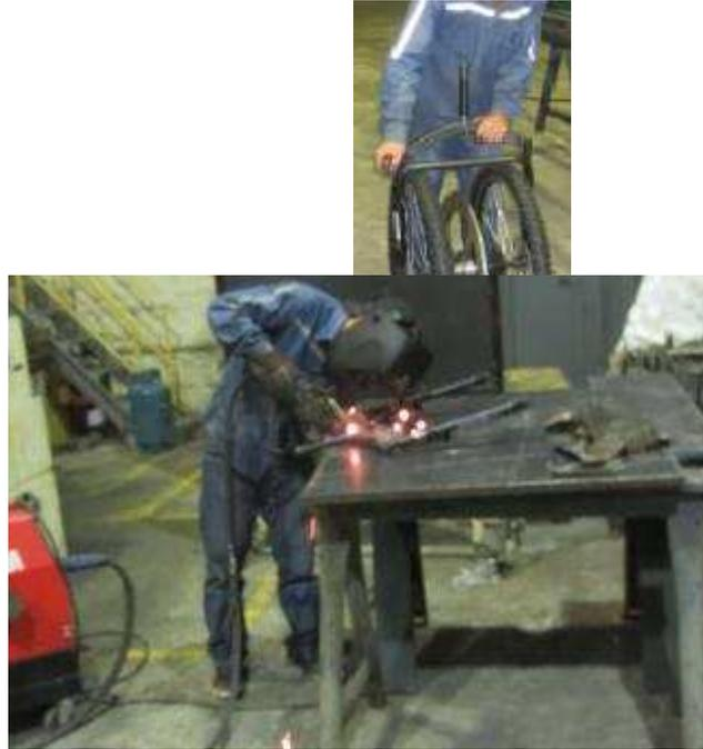
*Figura B.115 Fabricación del eje principal con ingeniería de detalle.*
