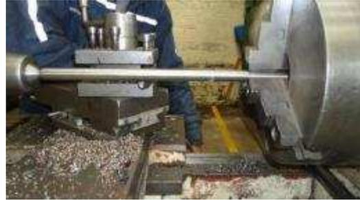
*Figura B.63 Moleteado en torno, para sujeción del rotor eléctrico*
