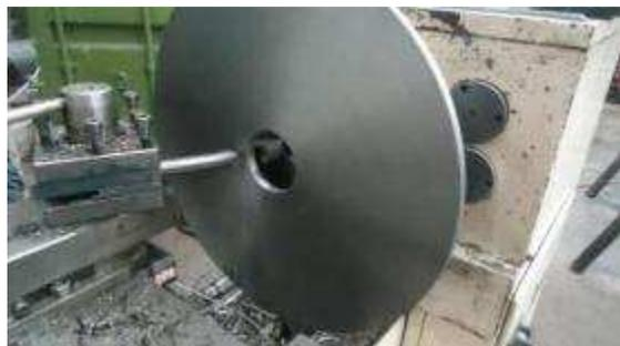
*Figura B.9 Reducción para el área de radios del volante.*
