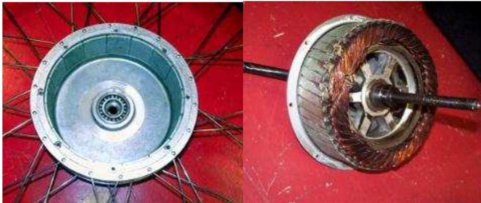
*Rotor de un Motor HUB*
