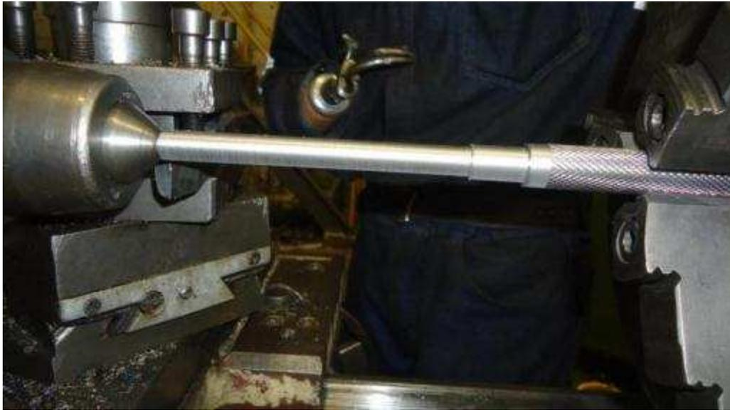
*Figura B.69 Roscado en el eje, deja diámetros menores a los extremos para que tenga región de salida la cuchilla.*
