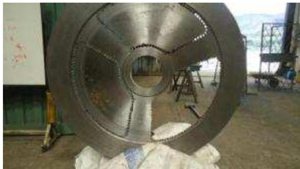
*Figura B.24 Fresado de perímetro anteriormente taladrado, utilización de cabezal divisor acoplado al taladro de pedestal (Tesis Ing. Wilson Cueva).*
