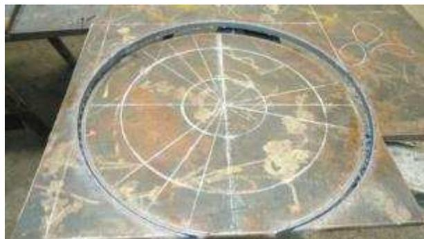
*Figura B.4 Soldadura de Anillo para mecanizado, proceso GMAW.*
