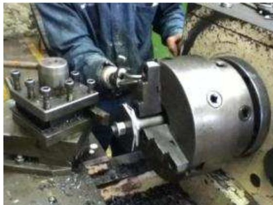
*Figura B.83 Taladrado entorno de anillos.    Figura B.84 Torneado interno.*
