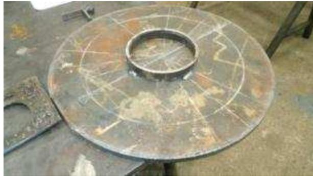
*Figura B.5 Centrado del anillo en el torno.*
