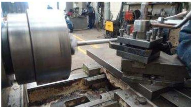
*Figura B.68 Torneado de geometría y preparación de superficie a roscar.*
