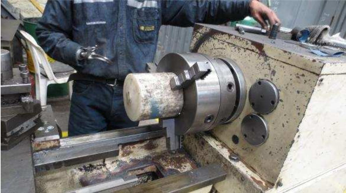
*Figura B.125 Montaje de anillos a presión y maquinado de la superficie interior.*
