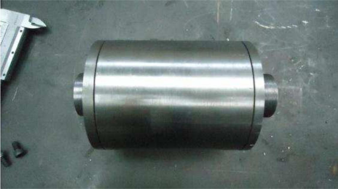
*Figura B.92 Montaje del eje principal.*
