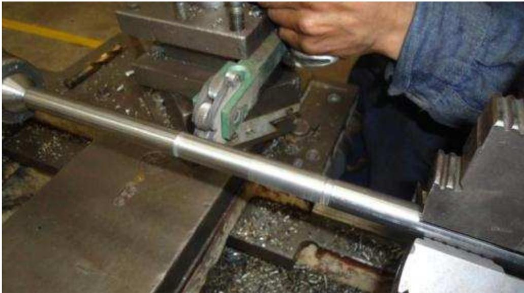
*Figura B.64 Moleteado en una dirección.    Figura B.65 Moleteado en dos direcciones.*
