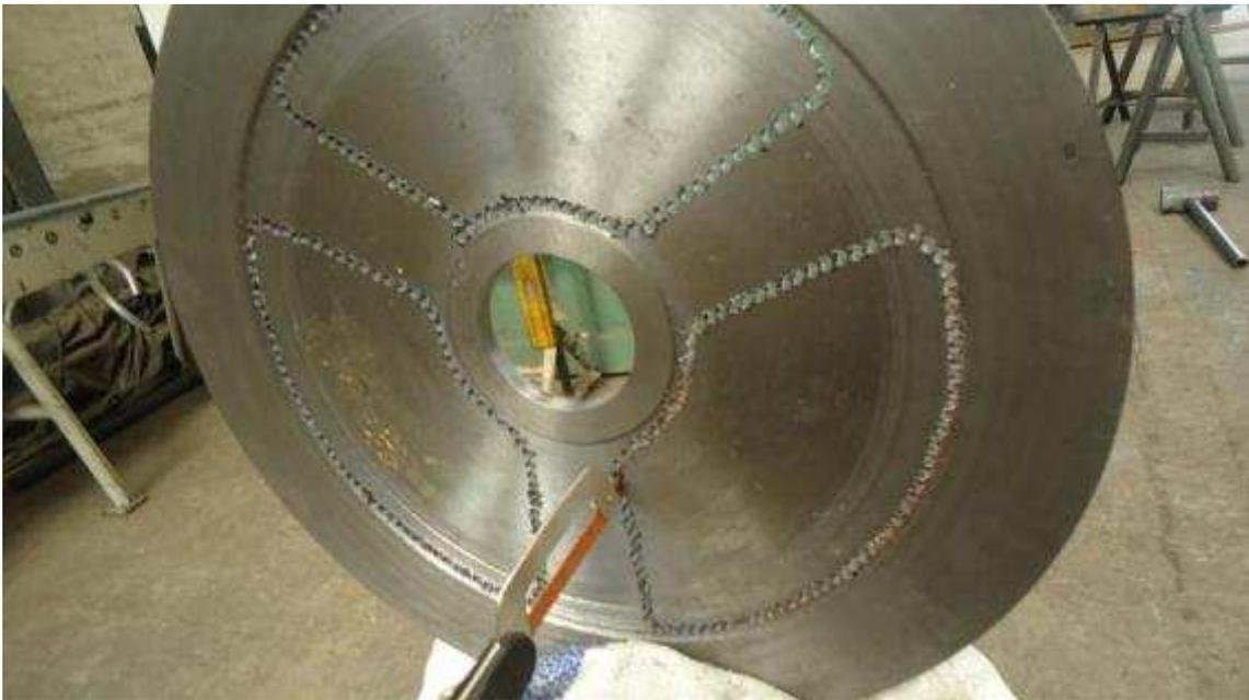
*Figura B.23 Corte completo y limado de superficies rugosas con Mototool.*
