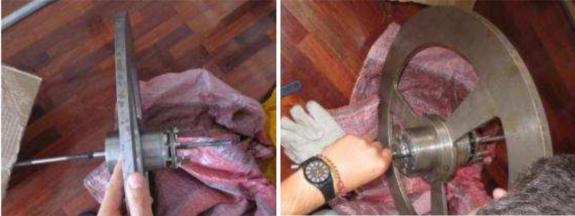
*Figura B.95 Ajuste de pernos Sistema Regenerativo.*
