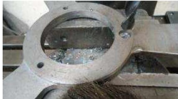
*Figura B.30 Eliminación de filos cortantes con broca de mayor diámetro.*
