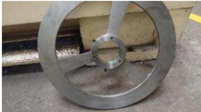
*Figura B.90 Volante y anillo acoplado al eje exterior hueco.*
