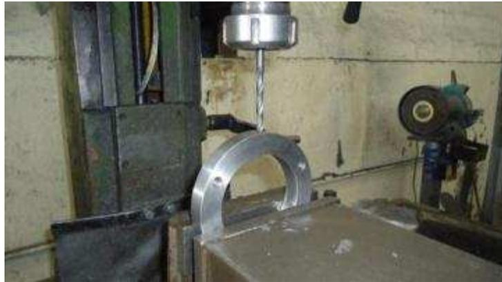
*Figura B.56 Puntos de suelda para centrado de agujeros en el volante de inercia. Se necesita alta centricidad.*
