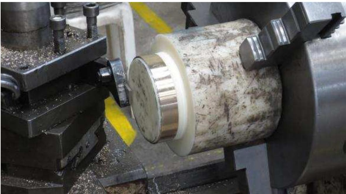
*Figura B.126 Separación de anillos y torneado interior.*
