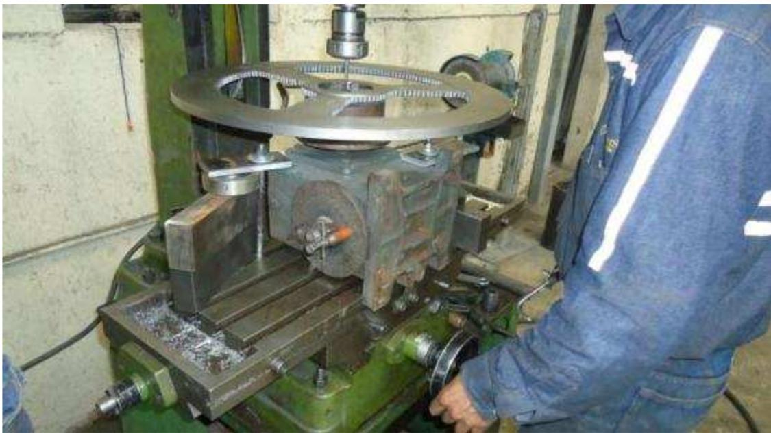
*Figura B.25 Fresado interno de superficie.*
