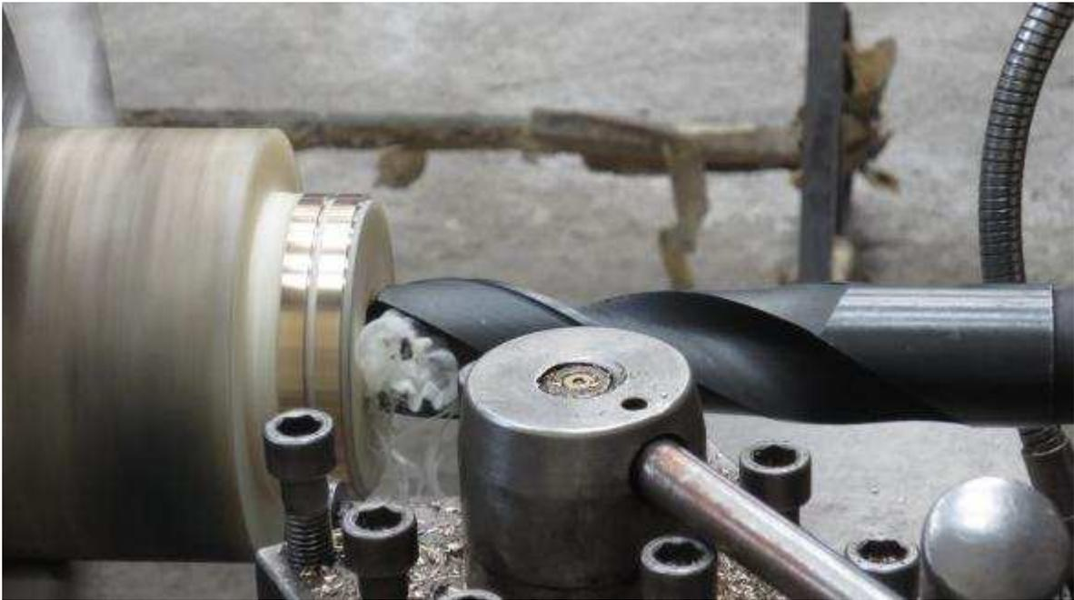
*Figura B.127 Comprobación de ajuste perfecto entre el estator y el porta anillos.*
