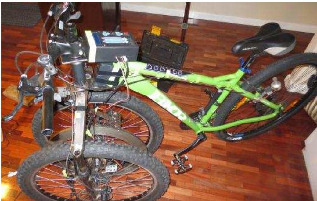
*Figura B.137 Ubicación de sensores, tanto de rpm del volante de inercia como el sensor de km/h de la bicicleta híbrida.*
