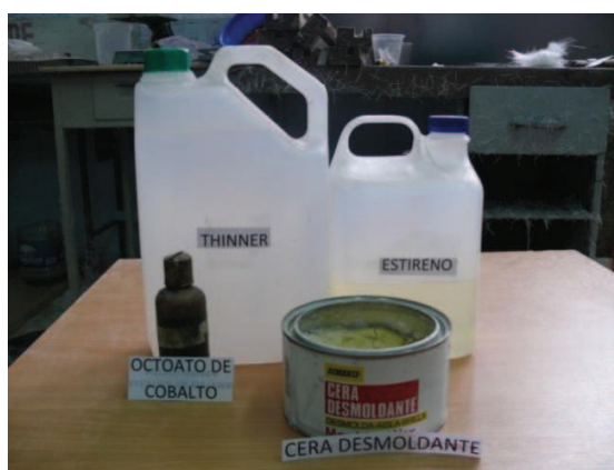
Figura 2.3. Varios materiales empleados en el proceso de moldeo por aspersión.
