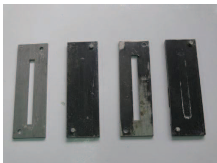
Figura 2.25. Moldes empleados en la obtención de probetas para ensayos de flexión de matriz poliéster.
