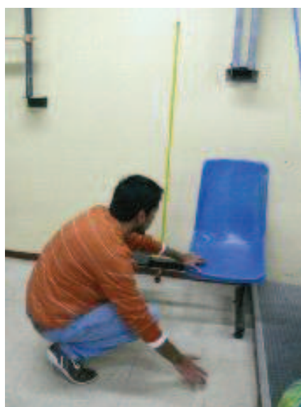
Figura 4.15. Caída de la carga de prueba e inspección del prototipo.
