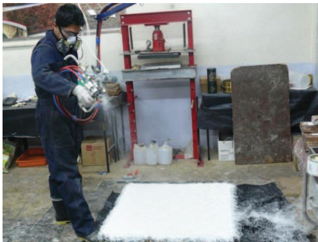
Figura 2.35. Moldeo por aspersión (capa simultánea de fibra de vidrio y matriz resina poliéster).
