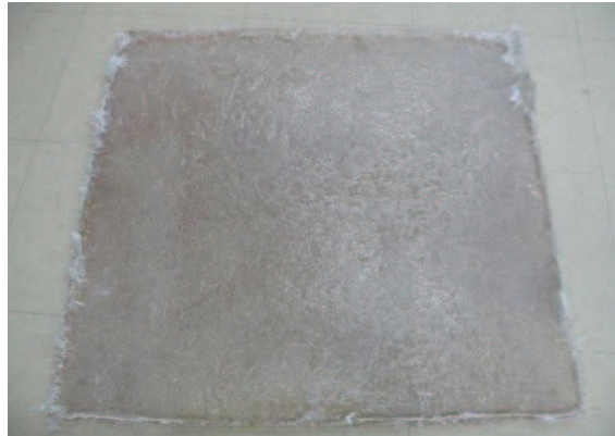
Figura 3.3. Tablero sin gelcoat.
