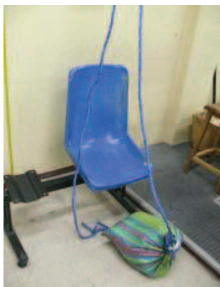
Figura 4.15. Caída de la carga de prueba e inspección del prototipo.
