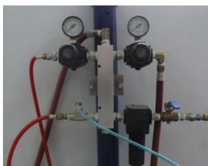
Figura 2.9. Manómetros para regulación de presiones de trabajo.
