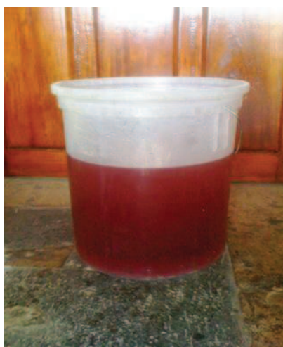
Figura 2.31. Resina poliéster mezclada con estireno y octoato de cobalto para utilizarla en el proceso de aspersion.
