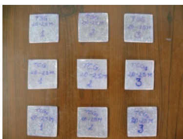
Figura 2.28. Muestras de materiales compuestos para incinerar.
