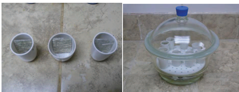
Figura 2.29. Muestras de material compuesto para determinación de la fracción volumétrica existente; a) colocada en crisoles; b) colocadas en un desecador.
