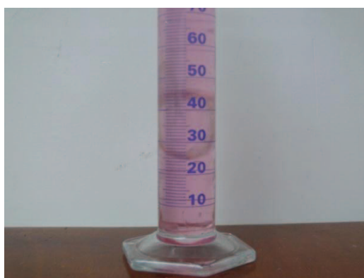
Figura 2.27. Inmersión de la muestra de refuerzo en resina poliéster preparada.
