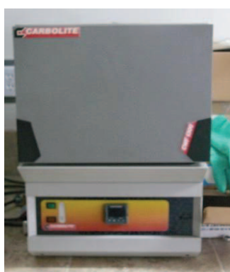
Figura 2.17. Horno eléctrico empleado en la incineración de las muestras.
