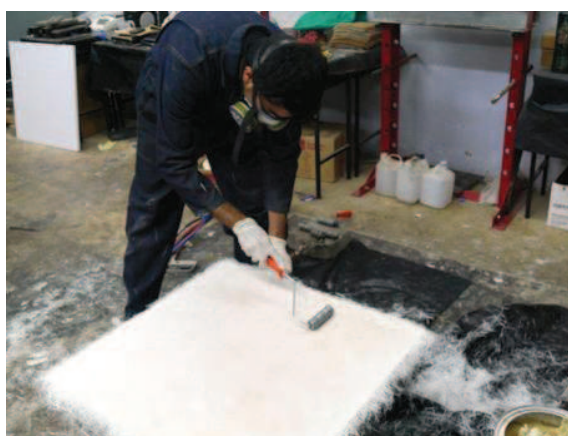
Figura 2.36. Proceso de laminación con rodillo.
