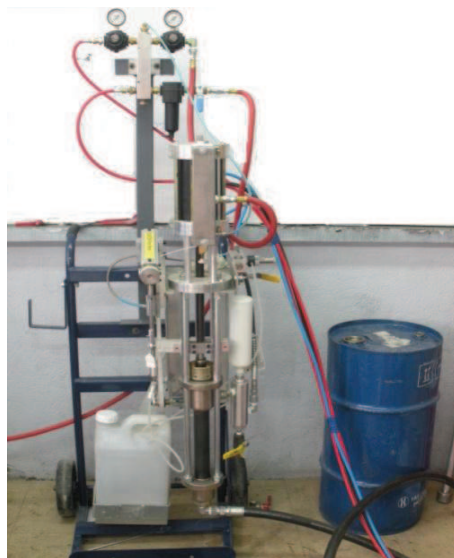
Figura 2.13. Equipo para aplicación de gelcoat MVP.
