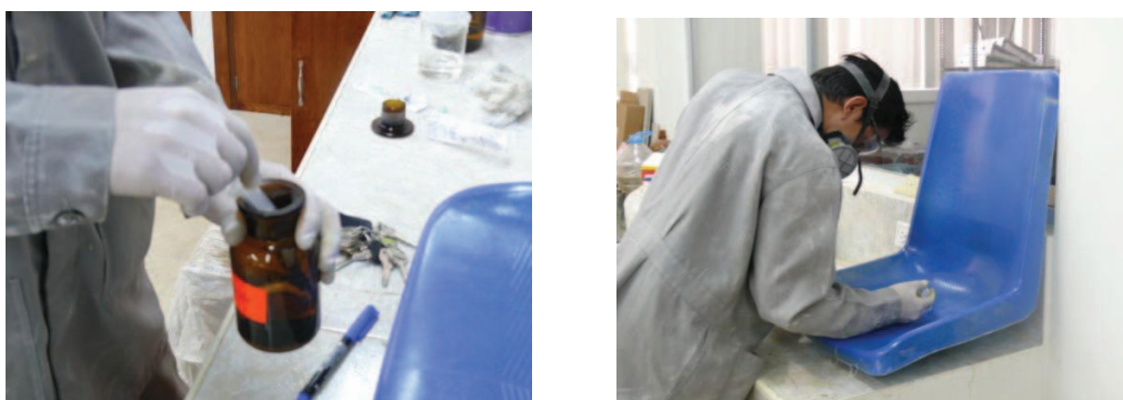
Figura 4.9. Aplicación de los agentes químicos sobre la superficie del asiento.
