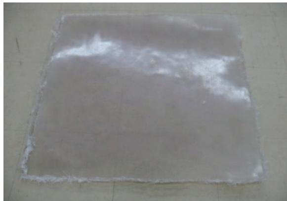
Figura 3.4. Tablero con gelcoat.
