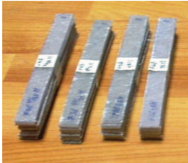
Figura 2.40. Probetas para ensayos a flexión.
