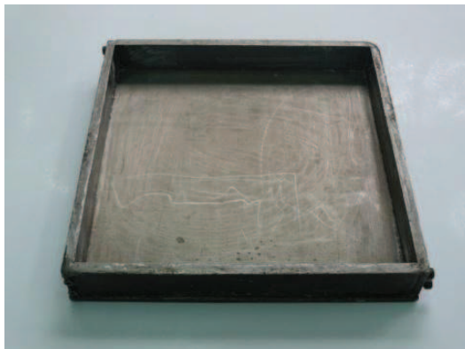
Figura 2.26. Molde empleado en la obtención de probetas para ensayos de impacto de matriz poliéster.
