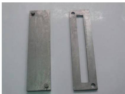
Figura 2.24. Molde empleado en la obtención de probetas para ensayos de tracción de matriz poliéster.
