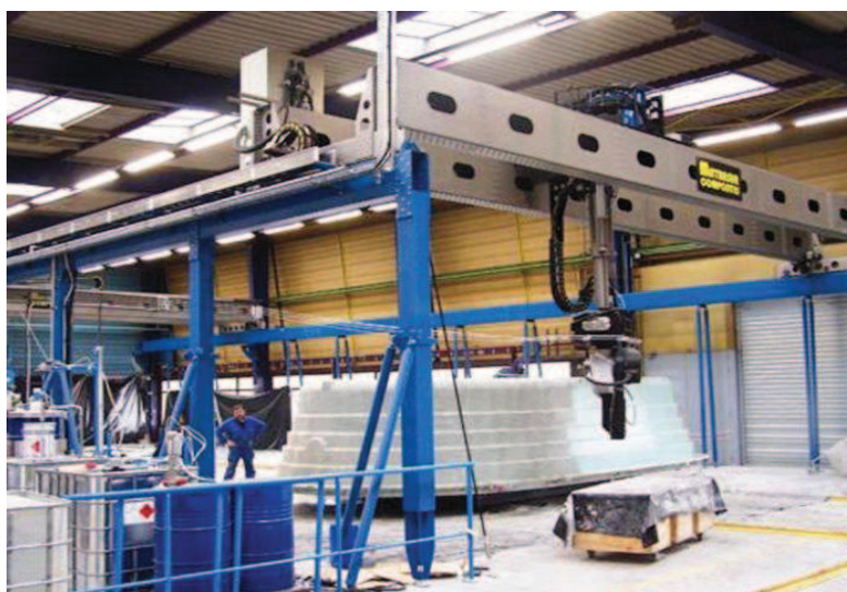
Figura 1.9. Brazo robótico para moldeo por aspersión. 18
