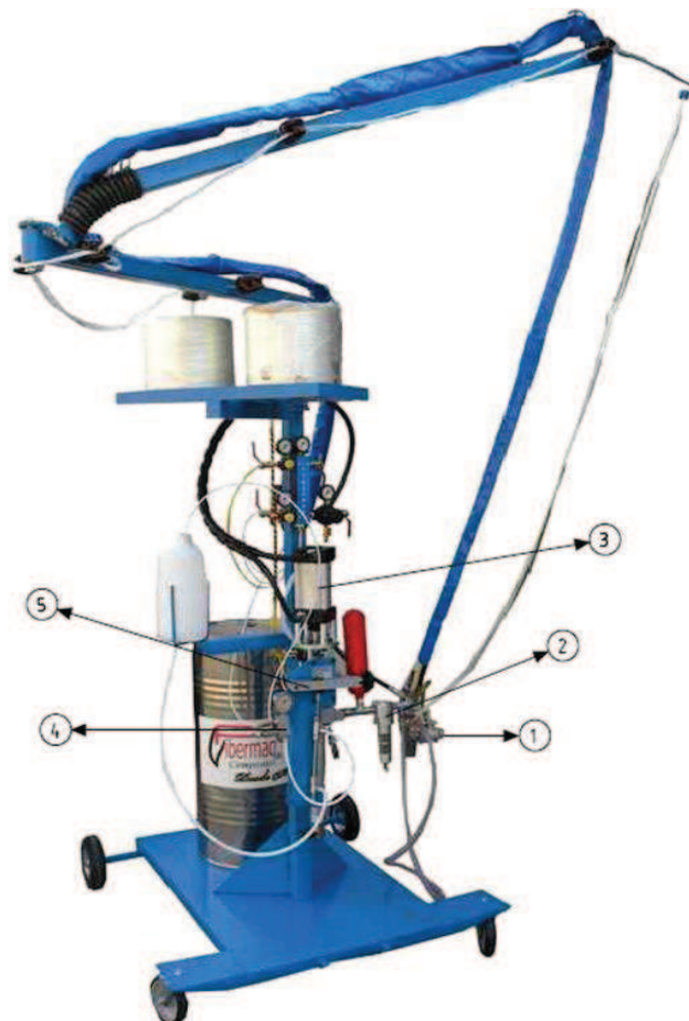
Figura 1.4. Identificación de componentes de la máquina de aspersión: 1. Pistola de aspersión; 2. Filtro de partículas; 3. Bomba de resina; 4. Válvula de alivio; 5. Bomba de catalizador (MEKP). 7
