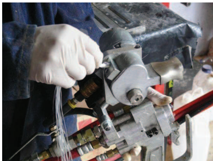
Figura 2.32. Colocación del roving de fibra de vidrio en el dispositivo de corte de la pistola de mezcla externa en la máquina de aspersión.
