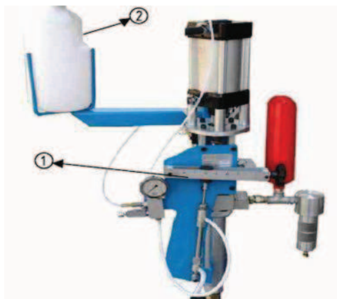
Figura 1.6. Posicionador de bombeo del catalizador y su almacenamiento: 1. Posicionador; 2. Tanque de almacenamiento del MEKP. 8
