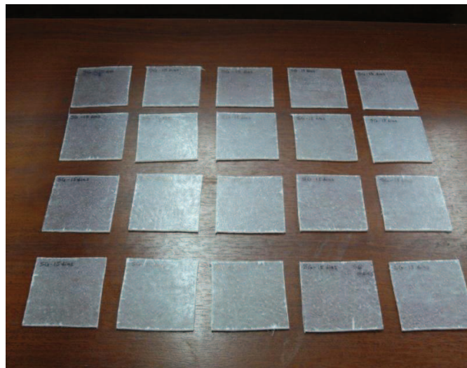
Figura 2.42. Probetas para ensayo de impacto.
