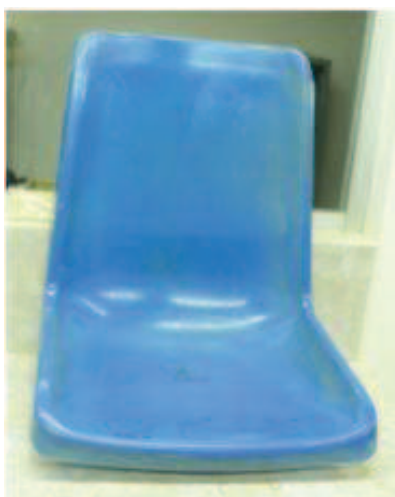
Figura 4.16. Prototipo posterior al ensayo de acción química.
