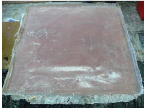
Figura 3.1. Tablero con deficiencia de catalizador en el curado, posiciones del dispositivo dosificador de MEKP entre 0,5 y 1,0.
