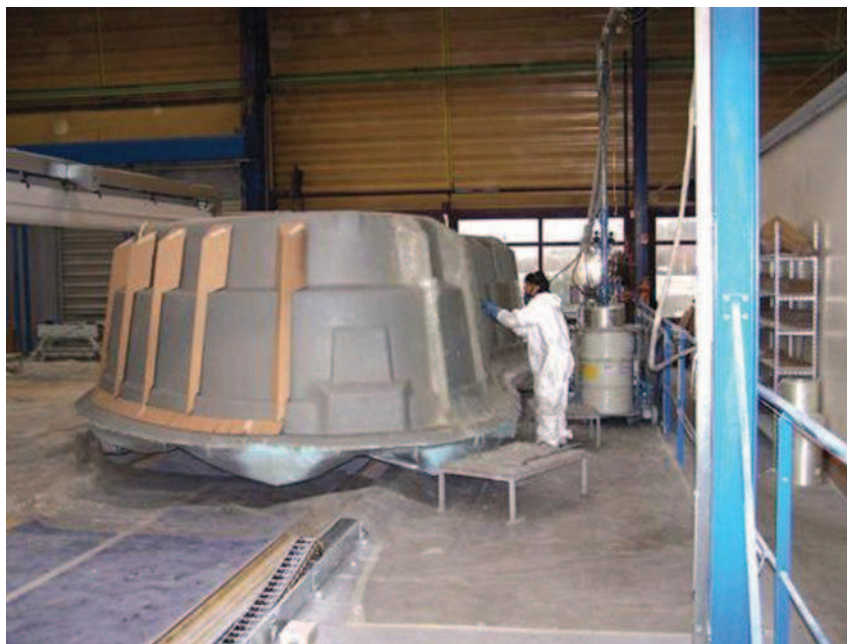
Figura 1.2. Proceso de aspersión (molde convexo). 6
