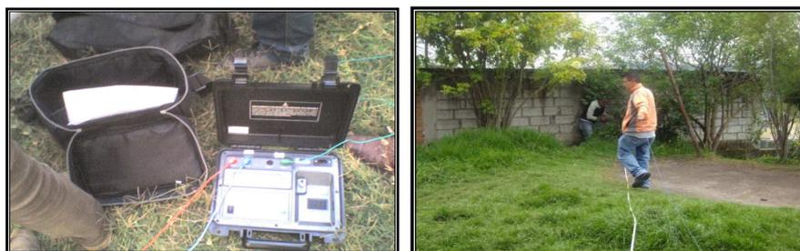
**Fig.7.3 Equipo para medir la Resistividad del Suelo.**
