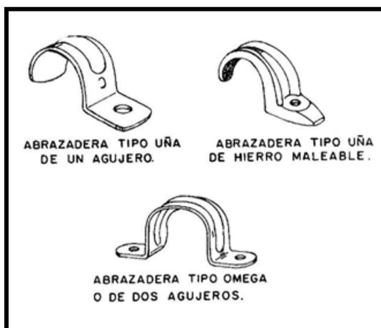
**Fig. 2.7 Abrazaderas para tubo conduit**
