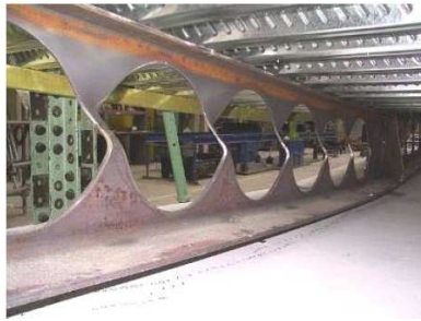
Figura 2. 33 Pandeo del post-alma en una viga celular
