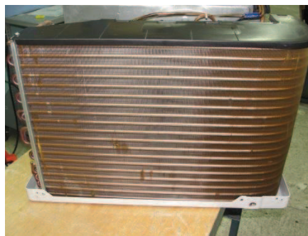
Figura 5.5 Condensador del equipo de pruebas 123
