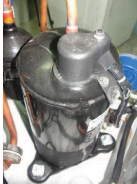
Figura 5.4 Compresor del equipo de pruebas 122
