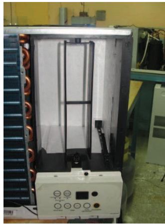
Figura 5.9 Cámara de salida del aire del equipo de pruebas 127
