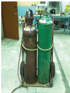
Figura 5.20 Tanques de acetileno (izquierda) y oxígeno (derecha) empleados en la soldadura 138
