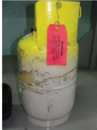
Figura 5.17 Tanque de almacenamiento de refrigerante recuperado (R-22) 135
