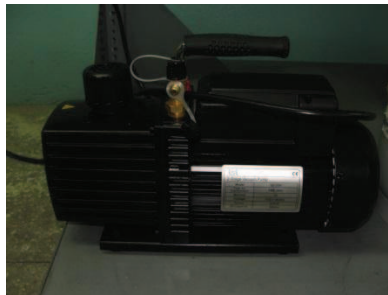
Figura 5.22 Bomba de vacío 140
