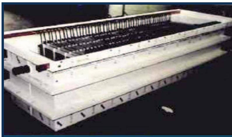
**Figura 1.11.** Fotografía de una celda electrolítica a escala industrial
