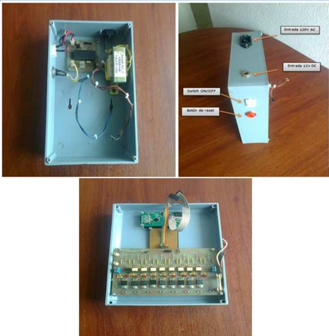
Figura 3.10 Ubicación interna de los componentes del controlador.
