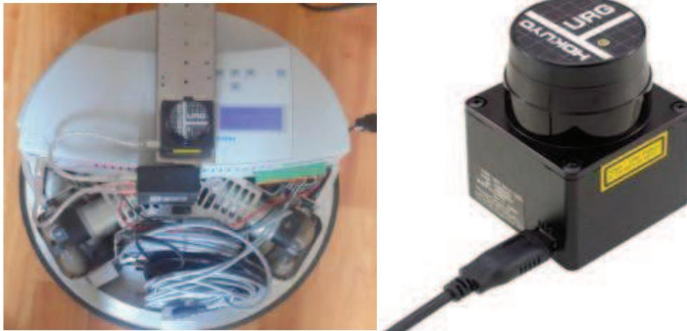
**FIGURA 2.8** (Izq.) Escáner Montado en Robotino®, (Der.) Láser Hokuyo URG-04LX-UG01
