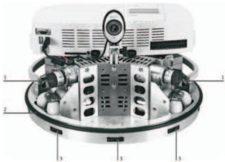
**FIGURA 1.8** Encoder incremental (1) Banda de impacto, sensor anti-colisión (2) Sensores de medición de distancia (3), Tomado de [16]
