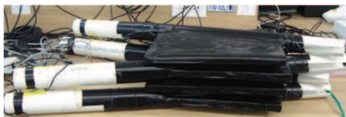
Figura 3.2: Contadores de Centelleo. Se llama contadores de centelleo al dispositivo compuesto por el plástico centellador con el fotomultiplicador. La forma de ensamblar se explica en la sección 3.3.1.
