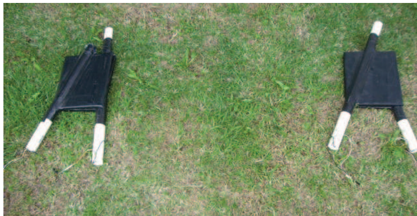
Figura 4.9: Disposición geométrica de los contadores de centelleo para medir el flujo de rayos cósmicos.
