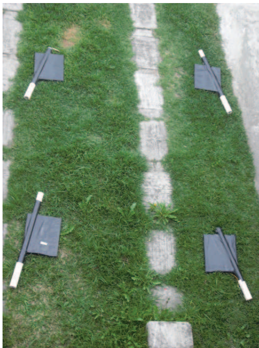
Figura 4.11: Disposición geométrica de los contadores de centelleo para recrear una lluvia de rayos cósmicos.
