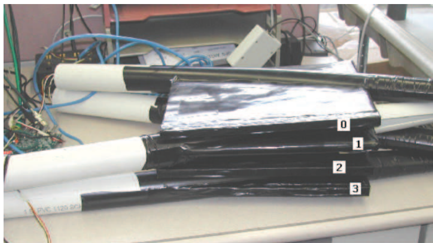
Figura 4.1: Apilamiento de los contadores para la calibración. Las etiquetas indican el número de canal de la DAQ al que tiene que estar conectado cada contador para tener esa posición en el apilamiento
