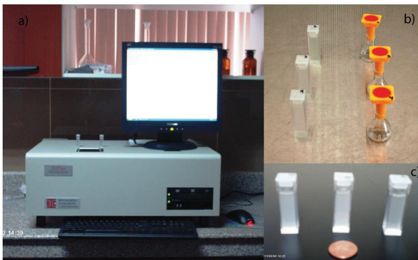
Figura 3.7: a) Equipo analizador de tamaños 90 Plus (Brookhaven Instruments Corporation. USA). b) Cubetas de acrílico y matraces usados para la evaporación del solvente. c) Cubetas de acrílico usadas para la medición
