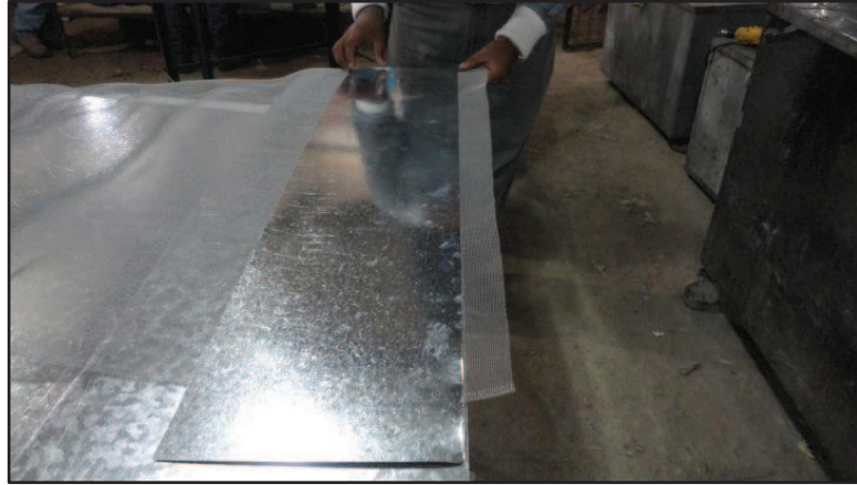
Figura 5. 2 Alineación de la malla de aluminio
