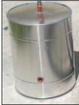
Figura 5. 22 Tanque de almacenamiento con capacidad de 25 litros
