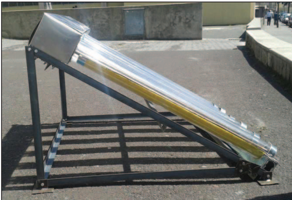
Figura 5. 27 Vista lateral del Colector Solar con Tubos de Calor
