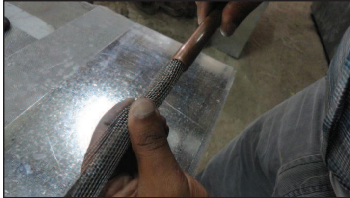
Figura 5. 4 Colocación de la mecha capilar adaptada en el interior del Tubo de Calor
