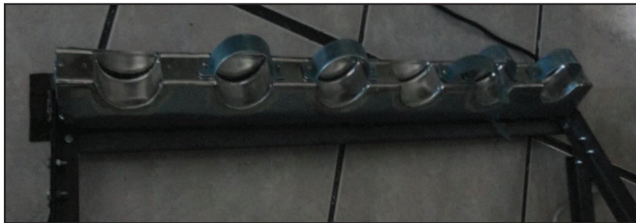
Figura 5. 11 Estructura de asentamiento de los tubos de acrílico
