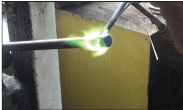
Figura 5. 7 Sellado del Tubo de Calor en la zona del evaporador
