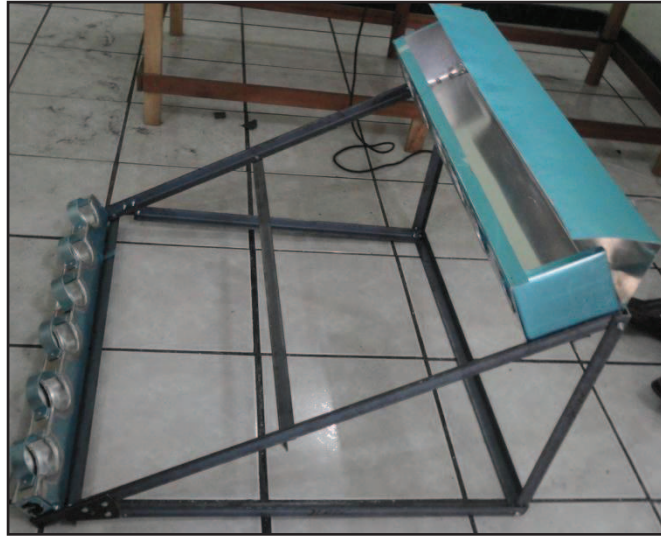
Figura 5. 12 Estructura soporte del Colector Solar
