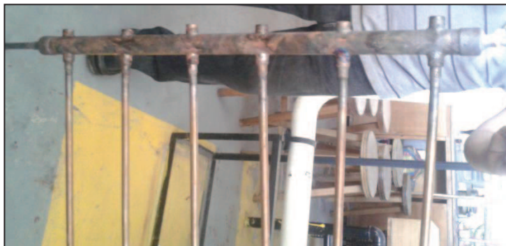
Figura 5. 16 Subconjunto cabezal de agua – Tubos de Calor
