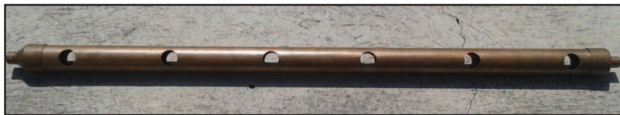
Figura 5. 15 Cabezal de agua del intercambiador de calor
