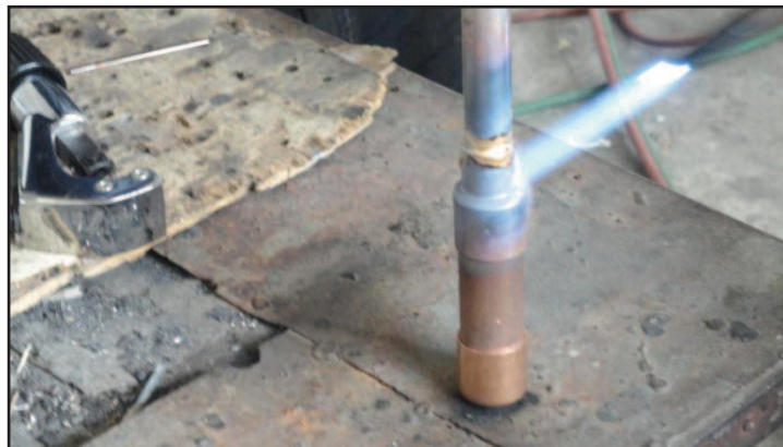
Figura 5. 5 Soldadura de la zona del condensador del Tubo de Calor
