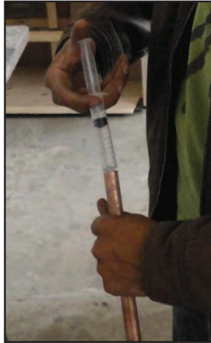
Figura 5. 6 Llenado del tubo de cobre con agua destilada.
