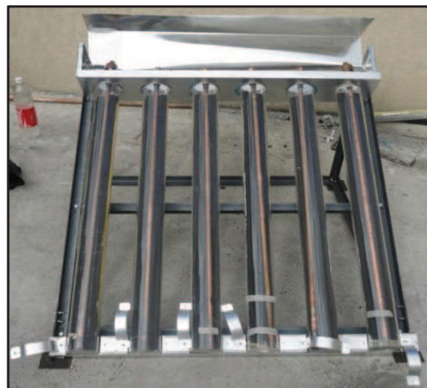
Figura 5. 24 Posicionamiento de tubos de acrílico con los Tubos de Calor en la estructura soporte
