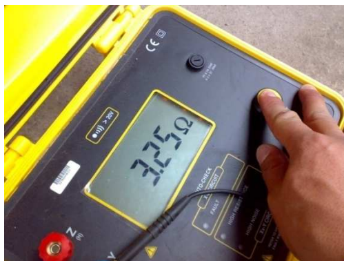
Foto 29. Medición de la malla a tierra.
