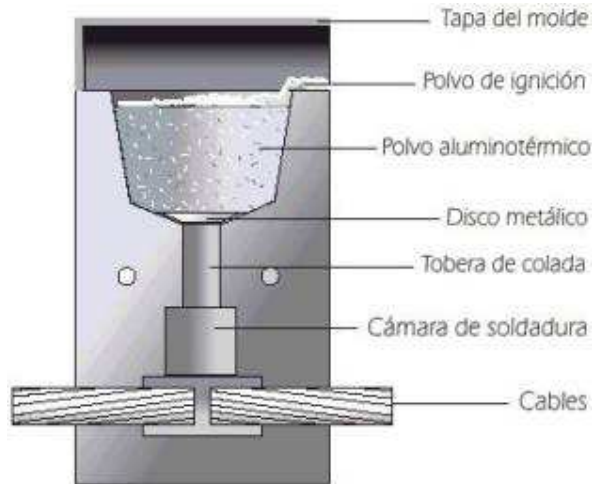
Figura 7.7. Partes de una suelda exotérmica.
