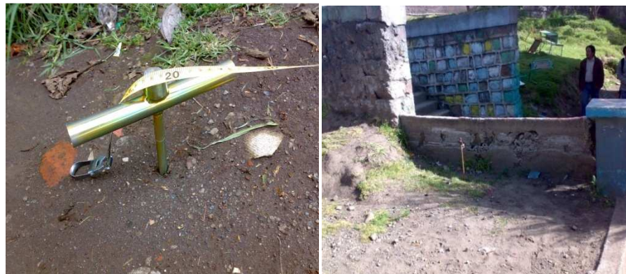
Foto 23. Medición de la resistencia del suelo.
