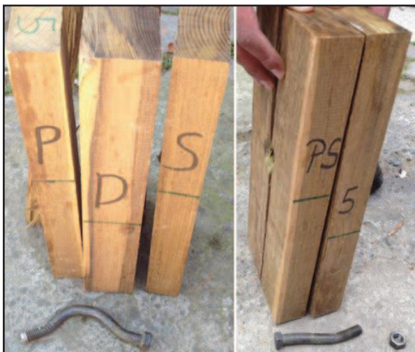
FIGURA 3.3: FALLA DE PROBETAS
