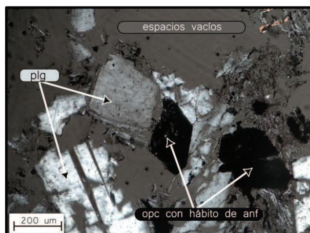
**Figura 3:17 Muestra DP-01-C. Vista al microscopio (objetivo10x), con luz polarizada. Minerales opacos con hábito de anfíbol. Abreviaciones: plg: plagioclasa, anf: anfíbol, opc: opaco.**
