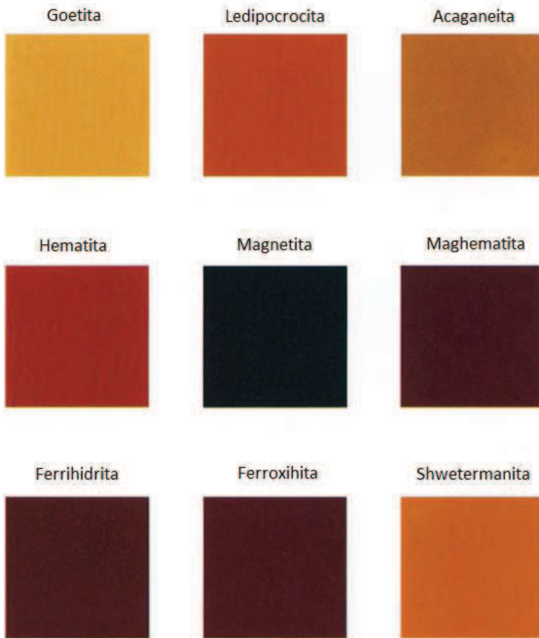
Figura A I.1. Color de los óxidos de hierro (Schwertmann y Cornell, 2000)
