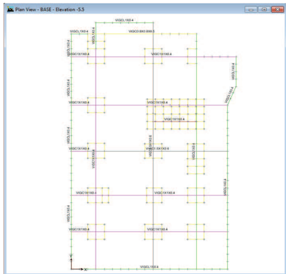
Figura 2.31: Vigas de cimentación optimizadas
