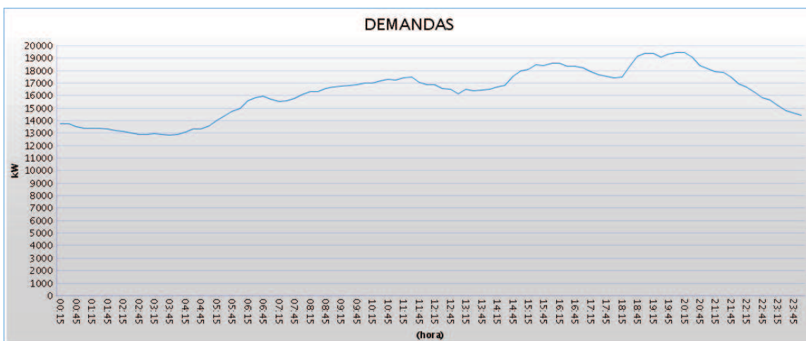
Figura 4.1 Curva de Demanda Subestación Sangolquí [14]
