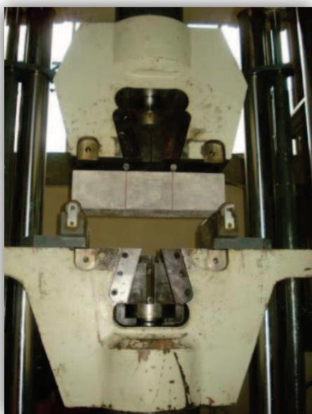
FOTOGRAFÍA 4.6: ENSAYO Y ROTURA A FLEXIÓN DE LA VIGA # 2 - 28 DÍAS, f'c = 240 \text{ Kg/cm}^2
