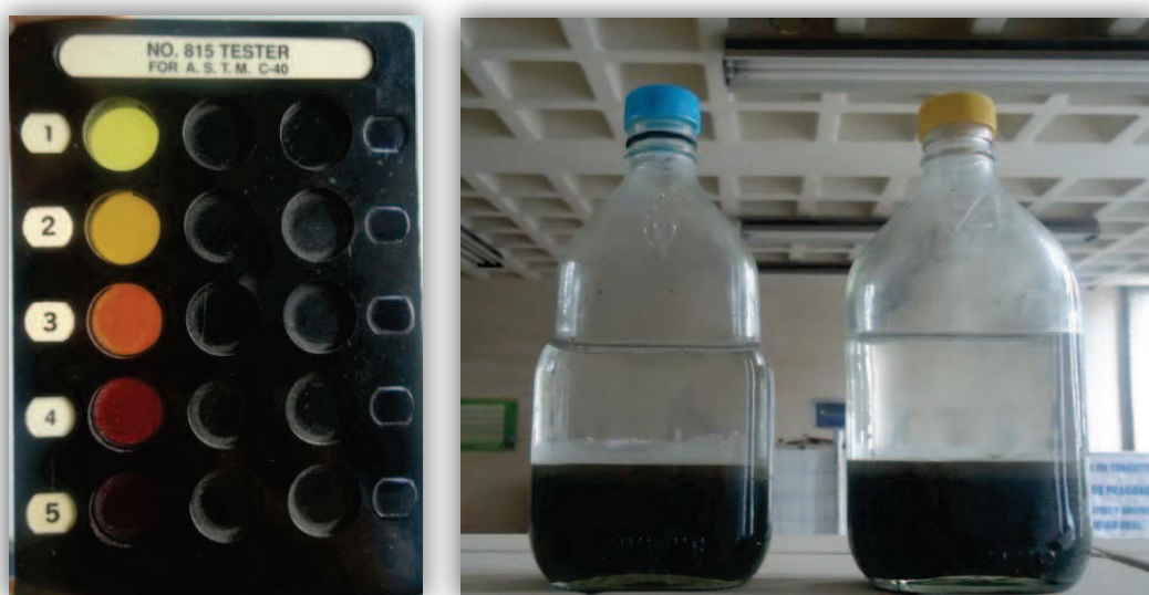
FOTOGRAFÍA 2.11: PLACA DE GARDNER – COMPARADOR DE COLOR
