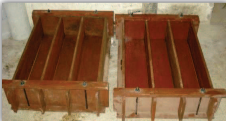
FOTOGRAFÍA 4.3: MOLDES DE VIGAS
