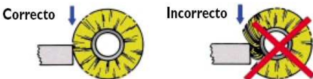
Figura 2.12 Forma correcta e incorrecta del uso de los cepillos metálicos.
