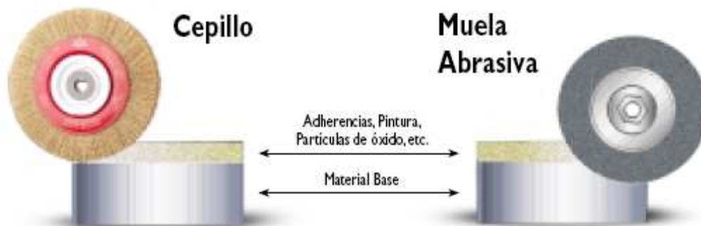
Figura 2.11 Diferencias entre cepillo metálico y muela abrasiva.
