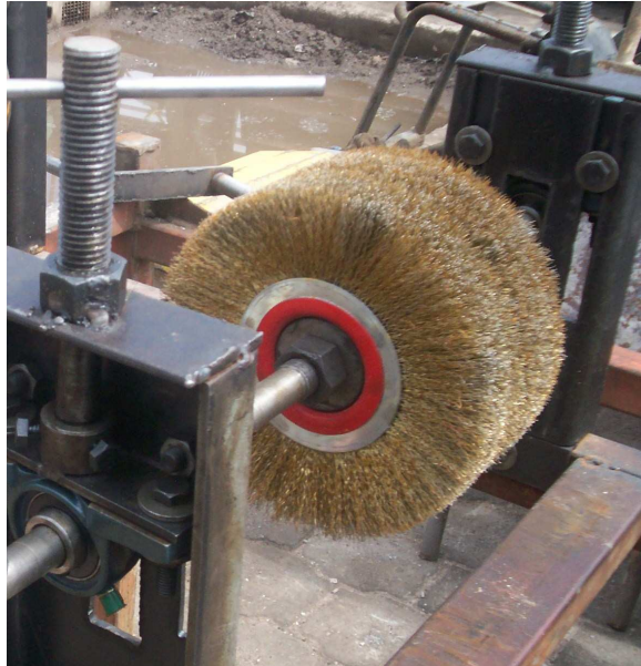
Figura 4.4 Pruebas realizadas cepillos rotación eje horizontal.
