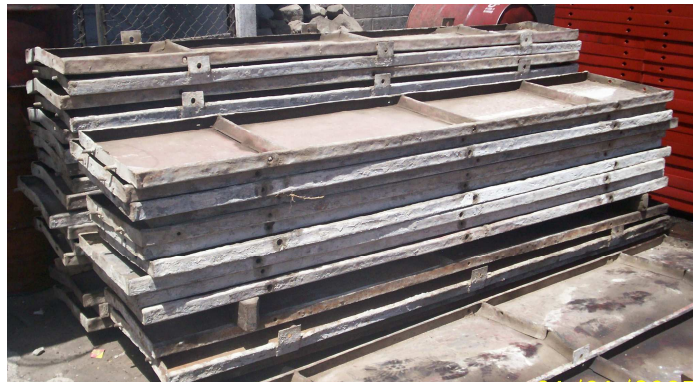
Figura 1.15 Tableros laterales de bordillo
