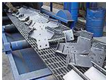
Transporte de las piezas a la granalladora
