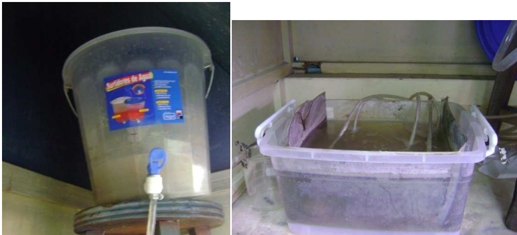
Figura 2.6 Recipiente de alimentación al reactor aerobio.
