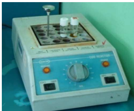
Figura AV.1 Reactor para análisis de DQO
