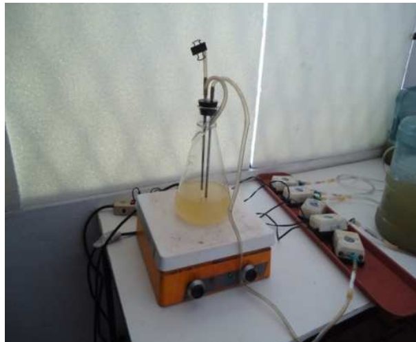
Figura 2. 5 Instalación del sistema masificador de bacterias
