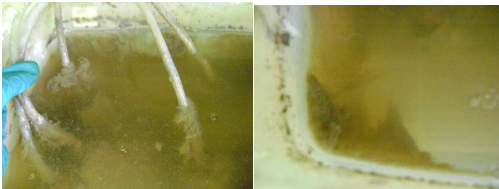
Figura 2.7 Crecimiento de la masa microbiana en el reactor aeróbico a escala de laboratorio
