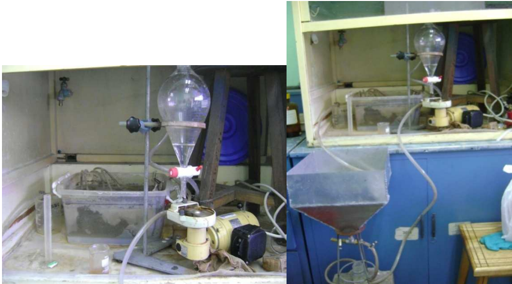
Figura 2.8 Sedimentador secundario y bomba peristáltica acoplados al sistema de tratamiento aeróbico del agua doméstica contaminada
