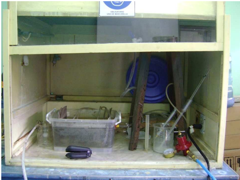
Figura AIV.2 Instalación del reactor aerobio de lodos activados a escala de laboratorio
