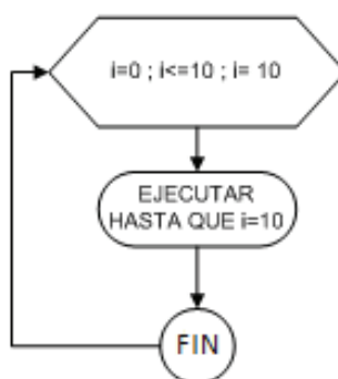
Diagrama de Flujo: 1. 2 Condición de repetición FOR – NEXT
